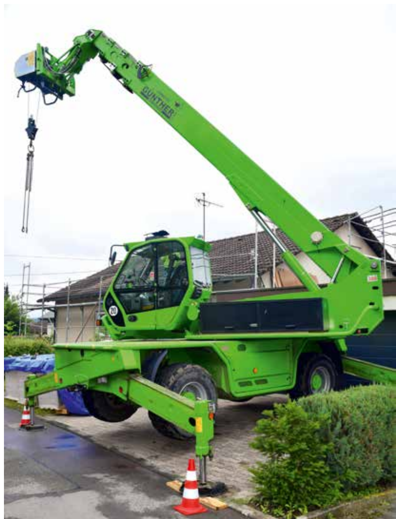
6 t-/24 m-Roto MCSS Teleskoplader als Zimmererkran mit drehbarem Oberwagen und vier einzeln vertikal und horizontal teleskopierbaren Abstützungen.
