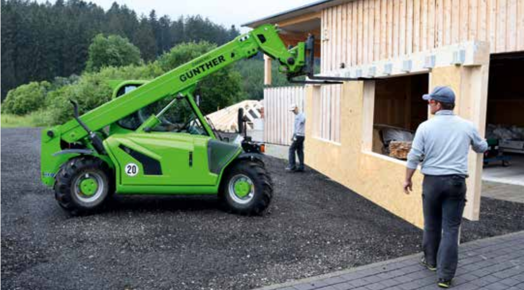
Kompakter Teleskop mit 1.920 mm Bauhöhe, 2,5 t Hubkraft und ...
