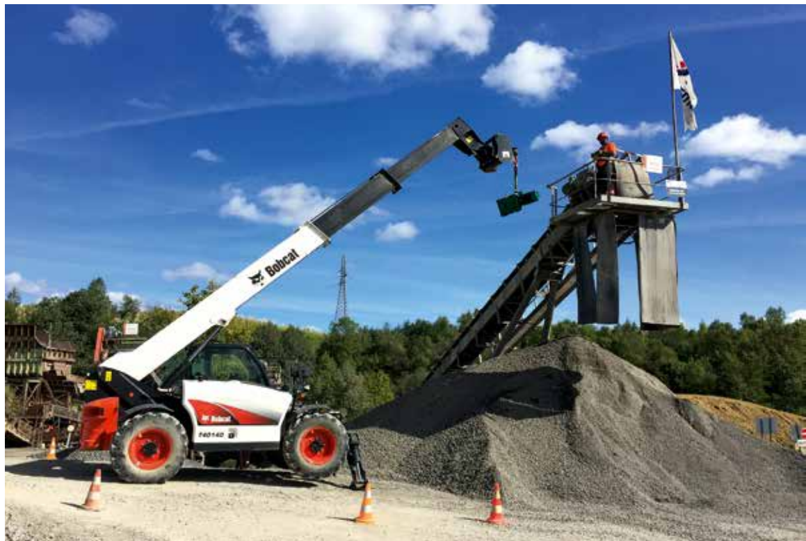
... mit Lasthaken zum Heben schwerer Gegenstände, ...
