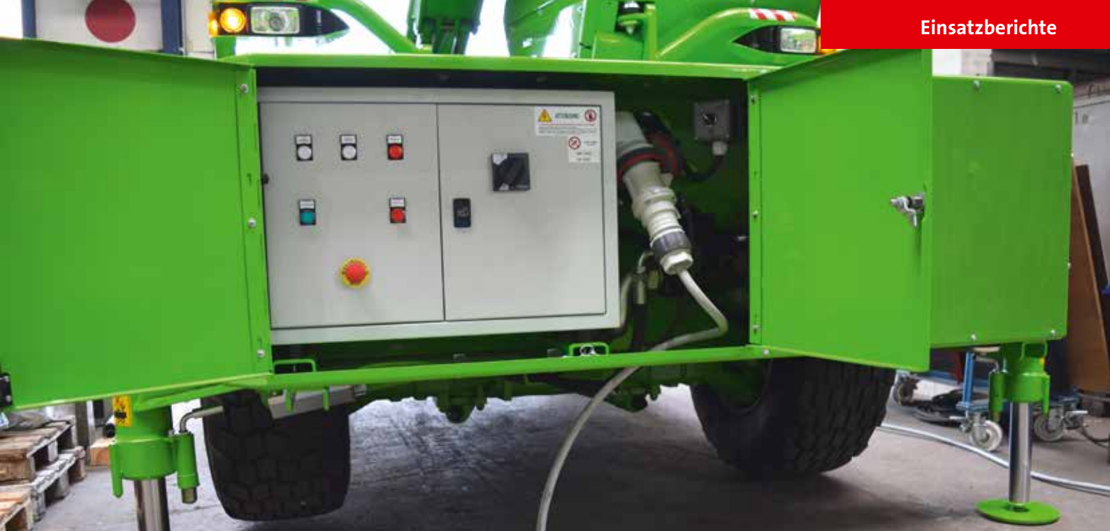
Front des Roto mit zusätzlichem E-Antrieb.
