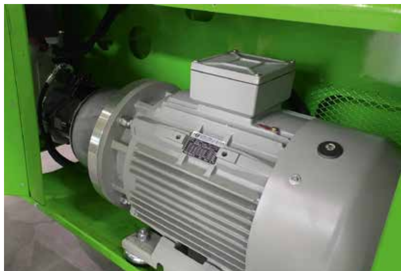
Der zusätzliche E-Motor für Merlo Rotoren.
