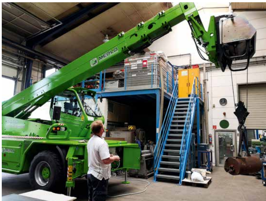
Merlo Roto mit Plug-In E-Antrieb.
