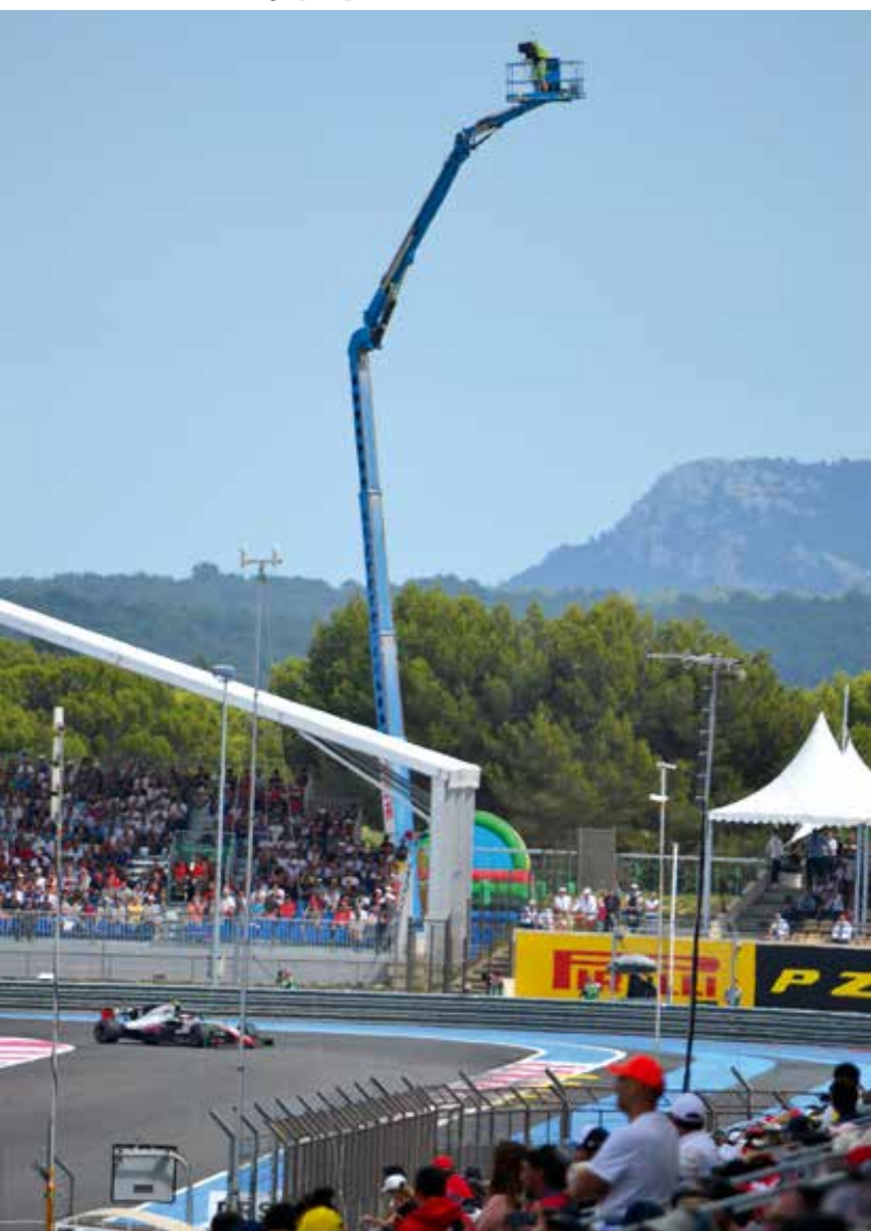
Die Genie Gelenkteleskop-Arbeitsbühne Z-135/70 von Freche Location im Einsatz beim Formel 1 Grand Prix in Frankreich.
