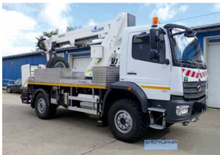
Für einen weiteren Energieversorger wurde ein GSR E180TJ auf einem Mercedes Atego aufgebaut.
