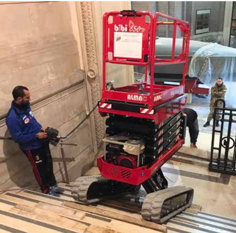
Das selbstnivellierende Raupenchassis der BIBI Scherenbühnen ...
