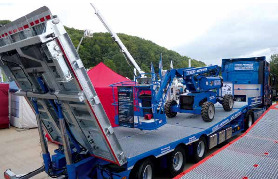
Dank des verkürzten Radstandes wird ein optimaler Schwerpunkt erzielt, sodass beispielsweise für den Transport einer Gelenkteleskop-Arbeitsbühnen lediglich eine 2-Achs-Zugmaschine benötigt wird.
