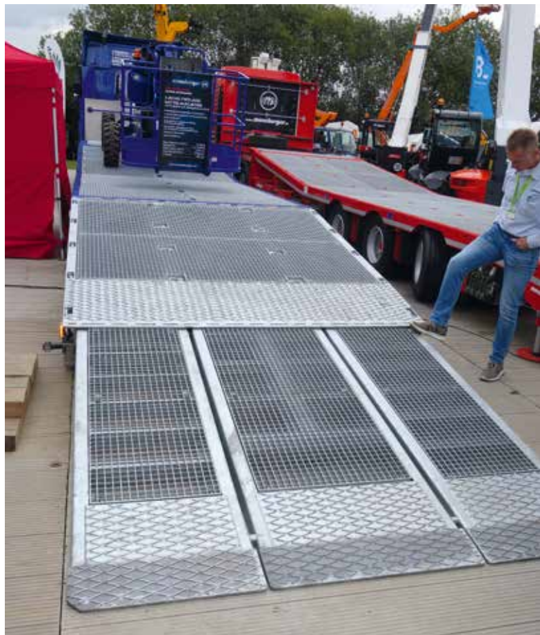
Der Spezial-Tieflade-Sattel von Meusburger auf den Platformers' Days 2017 in Hohenroda. Auf dem hinteren Teil der Auffahrrampe können bis zu 10 t angehoben werden.
