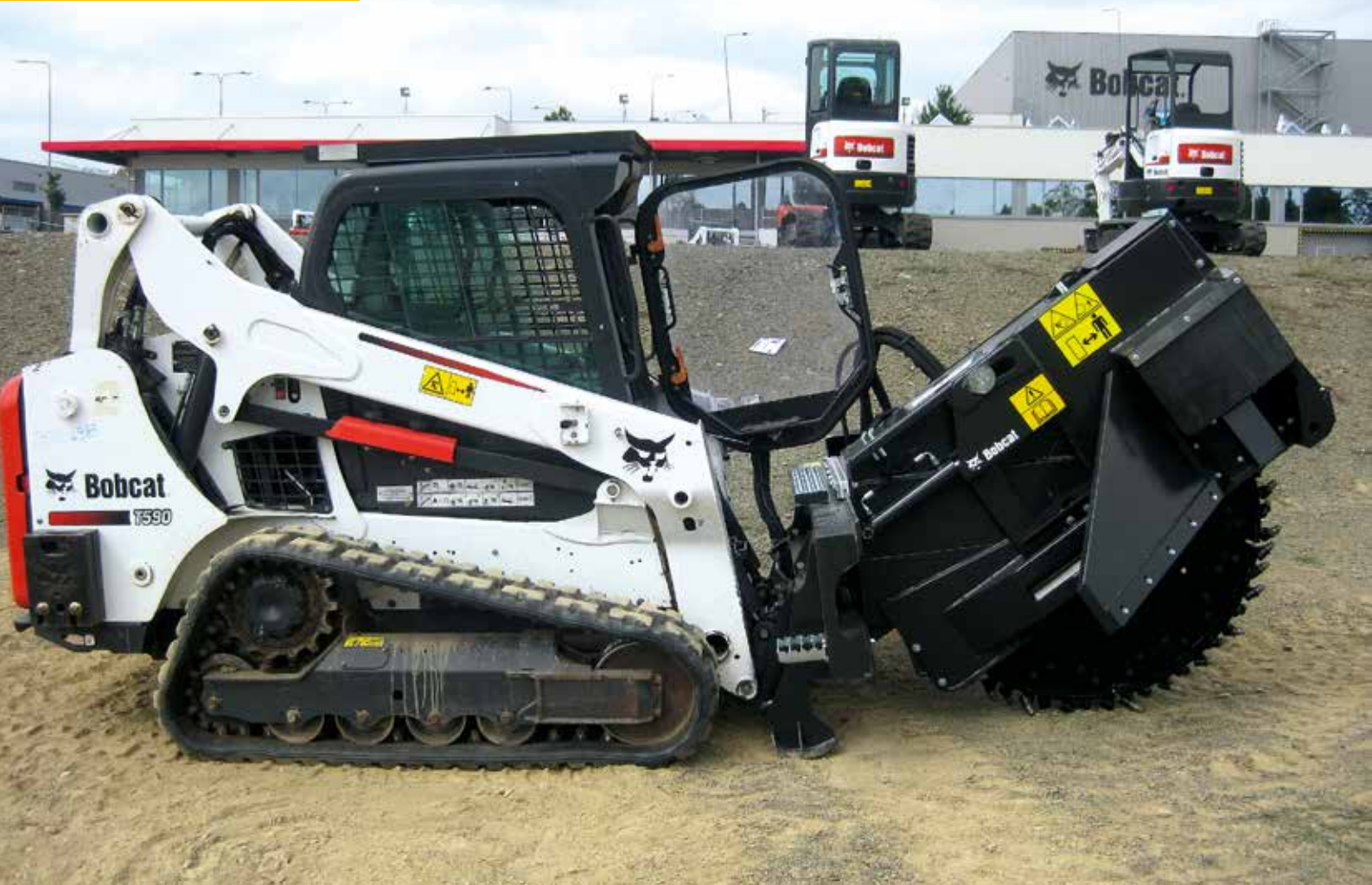
Ebenfalls neu auf dem Bobcat-Stand: die neue Radsäge WS SL20, die beispielsweise an dem T870 zum Einsatz kommen kann.
