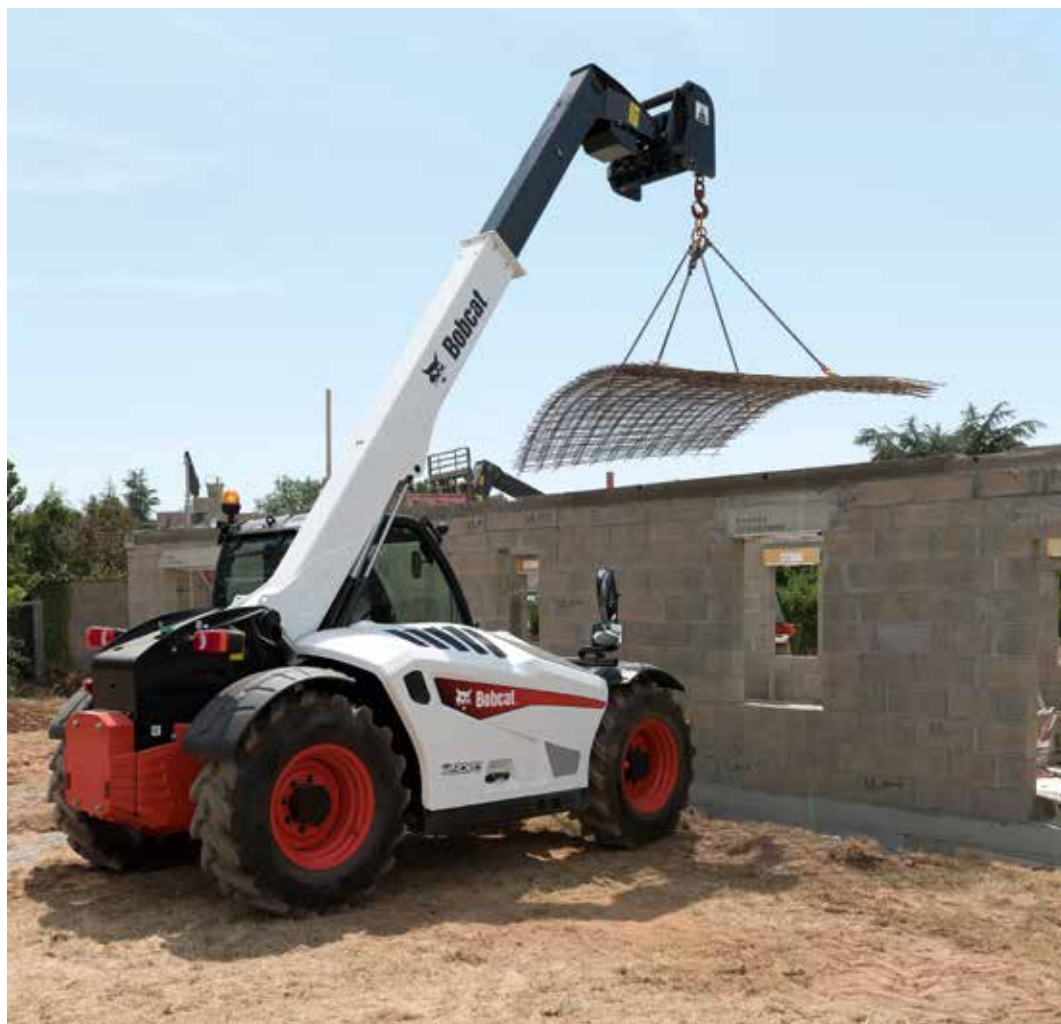
Der neue Bobcat Teleskoplader TL30.70 kann auch mit unterschiedlichen Anbaugeräten, wie beispielsweise Kranwinde ...
