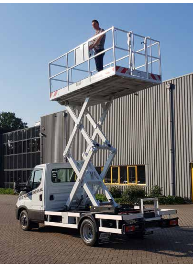
... sowie die auf 3,5-t-Lkw-Chassis montierte Scherenbühne CS6TM.
