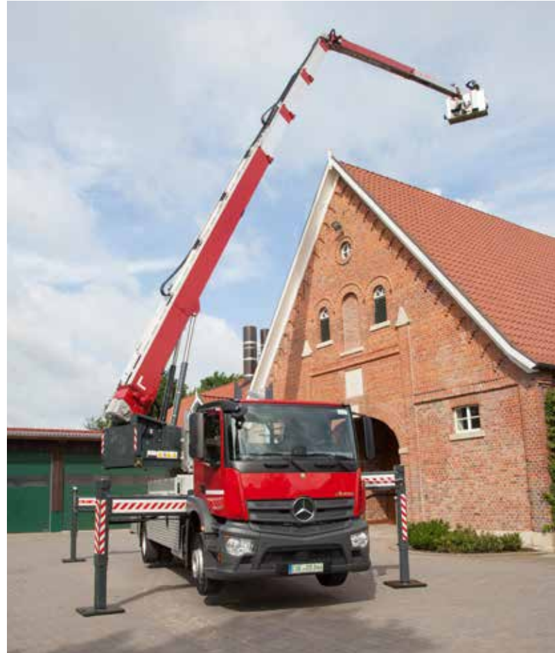
Die RSX-Modelle von Klaas sind mit einer teleskopierbaren Klappsitze ausgestattet. Diese ermöglicht das Aus- und Einfahren der Elemente „in der Luft“ und somit den Auf- und Abbau auch bei geringem Platzangebot – und das auch mit Arbeitsbühne.
