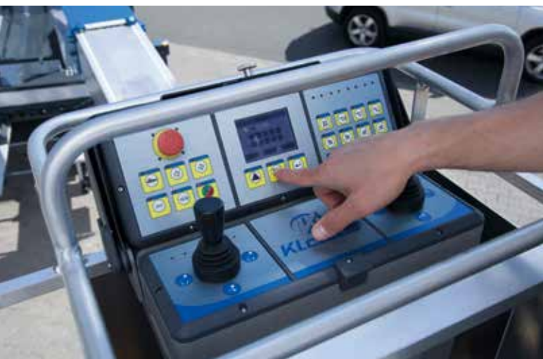
Über eine Maske im Display können Vermieter maximale Arbeitshöhe, Reichweite und/oder Drehwinkel der Hubarbeitsbühne reduzieren.
