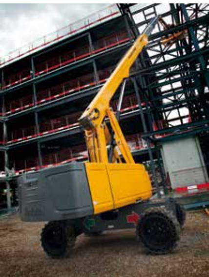
Die neue Haulotte Teleskop-Arbeitsbühne HT28 RTJ PRO (Arbeitshöhe 27,9 m, horizontale Reichweite 23,85 m) mit ACTIV' Screen, ACTIV' Lighting System, ACTIV' Shield Bar sowie der neuen Haulotte Start-Stopp-Automatik (Emissions- und Lärmschutz-System).
