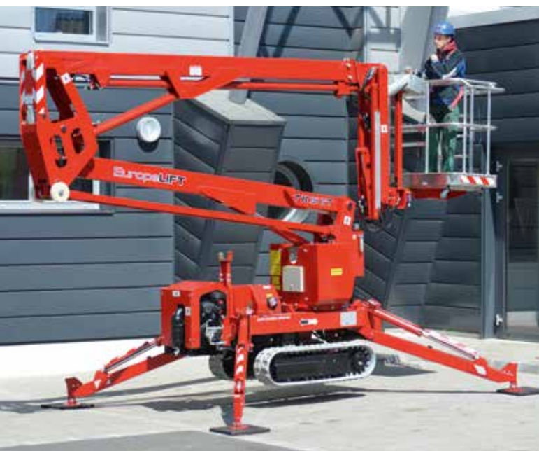
Mit einer minimalen Breite von 0,78 m meistert die Raupenbühne TR15GT von Europelift auch Normtüren.
