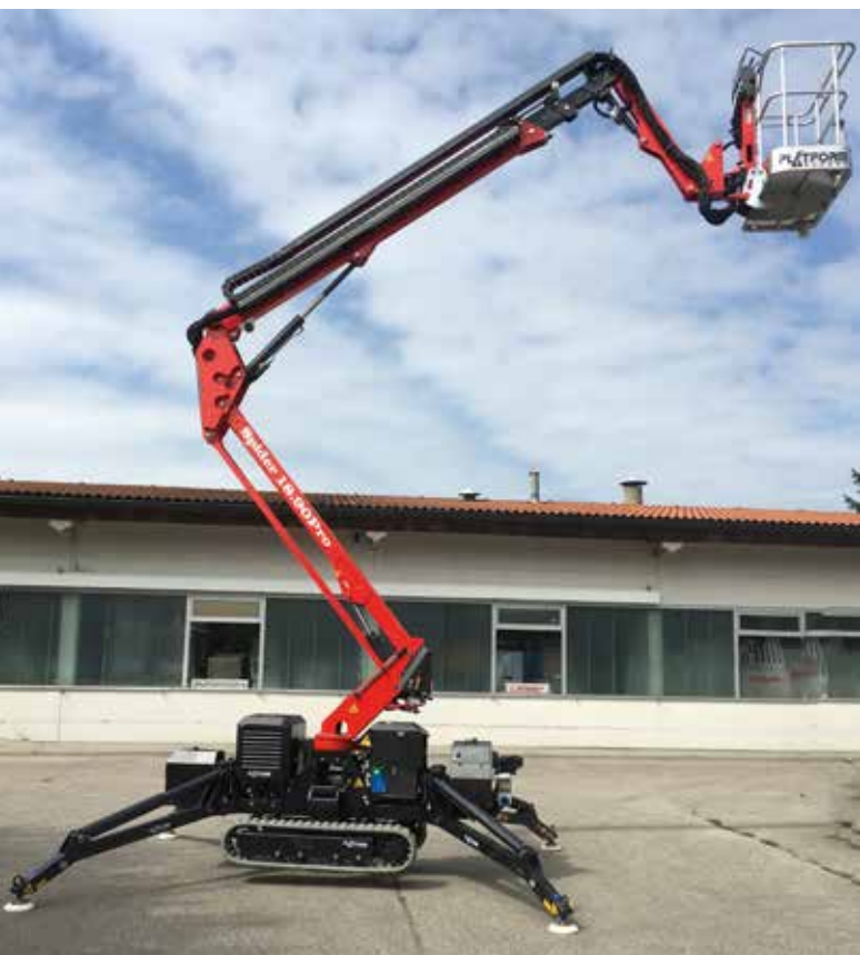
Ebenfalls auf den Platformers' Days ausgestellt: eine Raupen-Arbeitsbühne mit Lithium Batterieantrieb.
