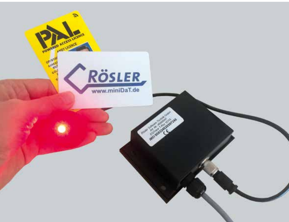
RFID ist eine weitere Rösler EQTrace-Anwendung. Mit ihr wird sichergestellt, dass nur der originäre Mieter mit der Maschine arbeiten kann.
