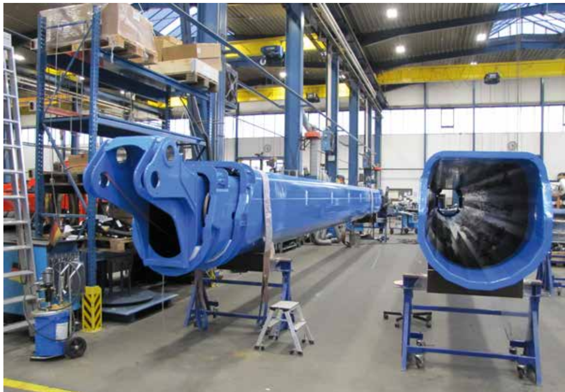
Die Teleskopträger sind fertig lackiert und zur Montage vorbereitet – die Teleskopträger des T 900 HF, die vielfach gekantet sind. Die „Vielkanttechnologie“ gewährleistet die gewünschte Stabilität und sorgt damit für ein sicheres, gutes Gefühl im Korb.
