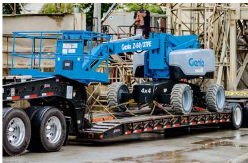
Die Genie Z-60/37 FE kann auf einem Standardanhänger transportiert werden, was sowohl den Aufwand als auch die Kosten des Transports minimiert.
