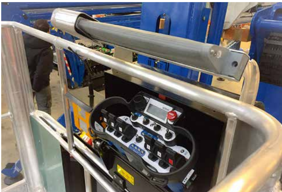
Die graue Abschaltleiste oberhalb des Steuerpults sorgt bei Berührung dafür, dass die angesteuerte Bewegung der Arbeitsbühne nach zwei Berührungs-Sekunden automatisch unterbrochen wird. Zusätzlich signalisiert die Sicherheitsausrüstung optisch und akustisch, dass der Bediener ggf. in Gefahr ist und Hilfe braucht.
