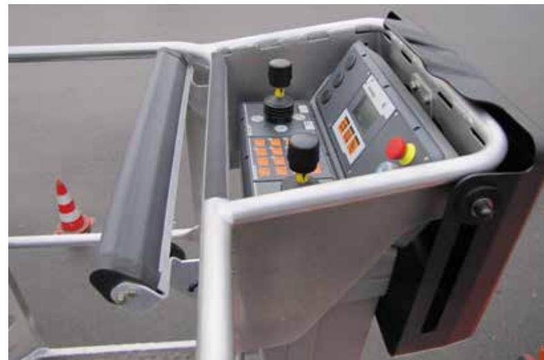
Durch Druck auf die Abschaltleiste stoppt das Secondary Guarding System die Bewegung des Steigers. Ein Hupsignal ertönt, um andere Personen auf den Vorfall aufmerksam zu machen und so ggf. eine Rettung der eingeklemmten Person einzuleiten.
