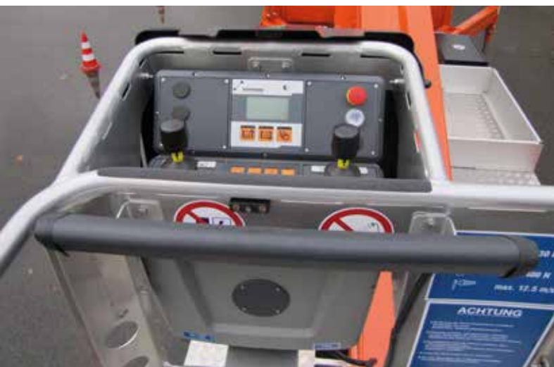
Das Secondary Guarding System ist eine unauffällige Schutzleiste, die direkt vor dem Steuerpult installiert wird.
