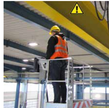
Die Gefahr lauert von oben: Wenn Bediener nicht aufpassen, droht die Gefahr der Einklemmung mit Hindernissen in der Höhe. Das Ruthmann Secondary Guarding System schützt die Hubarbeitsbühnen-Bediener vor diesem Risiko.
