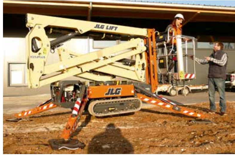
Die kompakte JLG Raupenarbeitsbühne X15J Plus ist klein und leicht, kann aber 230 kg im Korb bewegen.
