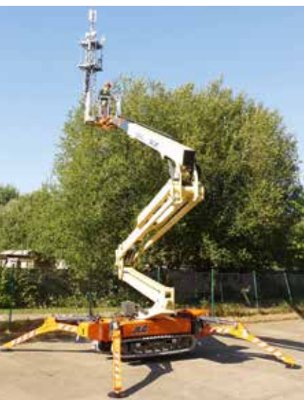
Mit der größten JLG Raupenarbeitsbühne kann man in knapp 26 m Höhe arbeiten und 13,75 m weit reichen, inklusive 230 kg Personen, Material und Werkzeug im Korb.
