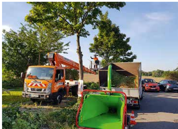
Großauftrag für das Baumpflege-Team Willms zum Auftakt der Herbst/Winter-Schnittsaison 2017 – 2.000 Bäume sollen in Form geschnitten werden. Bei solchen Aufgaben sind Arbeitsbühnen gefragt, die flexibel eingesetzt werden können, einfach zu handhaben sind und zudem über markante Leistungsdaten verfügen. Also perfekt für den abgebildeten Ruthmann Steiger TB 270+. Mit 16,4 m Reichweite und 27 m Arbeitshöhe ist er einer der leistungsstärksten Lkw-Arbeitsbühnen der 3,5 t-Klasse.
