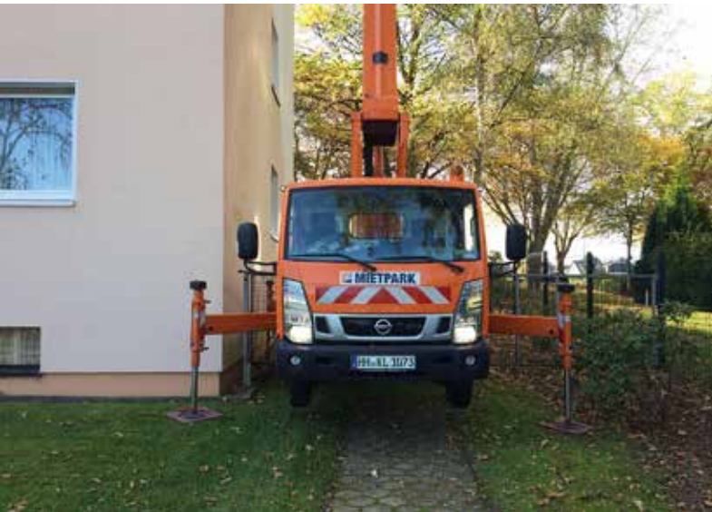
Dank seiner kompakten Maße (einer Baulänge von nur 6,86 m und 2,99 m Höhe) und ausgestattet mit der Horizontal-Vertikal-Abstützung (für Abstützung im Fahrzeugprofil, einseitig oder wie abgebildet komplett), ist der TB 270+ auch ein optimaler Allrounder für den Innenstadtbereich. Ohne großen Aufwand, beispielsweise ohne die Lkw-Arbeitsbühne ständig versetzen zu müssen, konnten nötige Reparaturen an der Hauswand erledigt werden.
