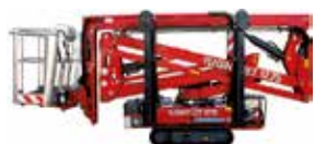
LIGHTLIFT 17.75 IIS Arbeitshöhe 17,00 m seitliche Reichweite 7,50 m Tragkraft Korb 230 kg
