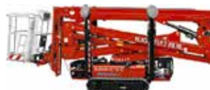
LIGHTLIFT 20.10 IIS Arbeitshöhe 20,10 m seitliche Reichweite 9,70 m Tragkraft Korb 230 kg
