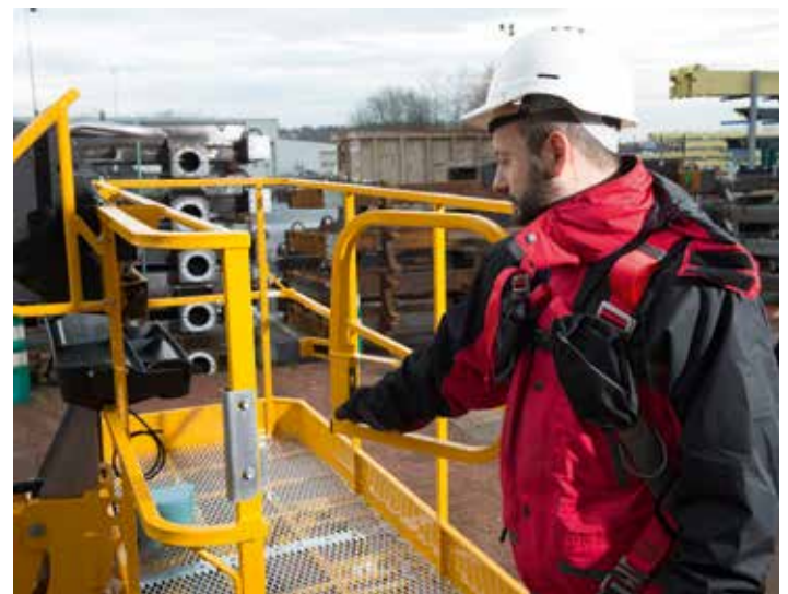
Die neue Gelenk-Arbeitsbühne Haulotte HA26 bietet einige Sonderausstattungen wie die seitliche Schwingtüre.
