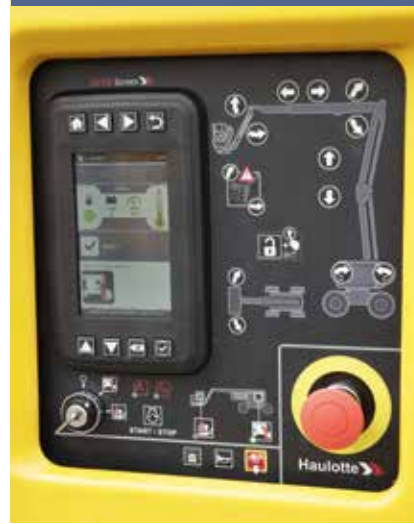
Das neue Haulotte ACTIV'Screen ist ein intelligentes Analyse-Tool, das den direkten, werkzeuglosen Zugriff auf Maschinen- und Diagnose-Parameter ermöglicht.
