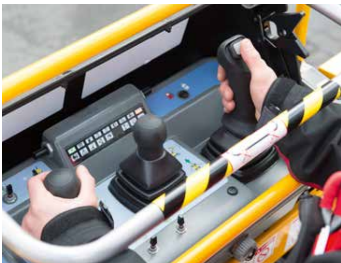
Haulotte ACTIV'Shield Bar 2.0 reduziert das Risiko von Quetschungen. Das Bedienpult sorgt für präzise Steuerung der Maschine.
