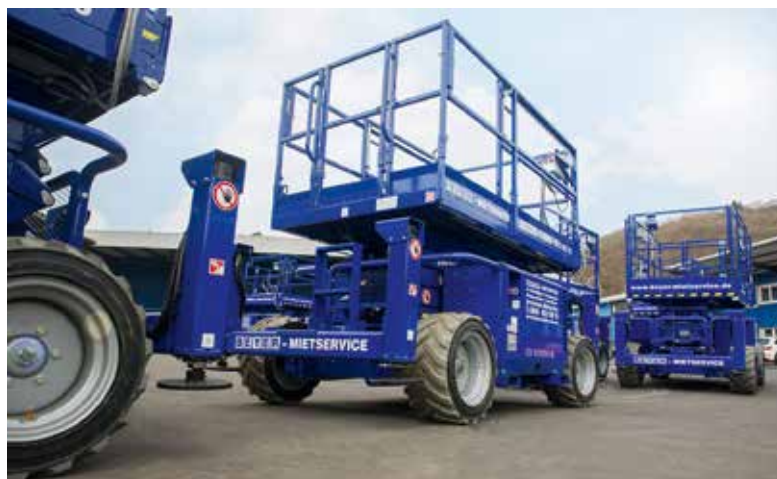
Die Diesel-Scherenbühne SB 117 SDC II überzeugt mit non-marking-Bereifung und Allradantrieb sowie optimaler Traktion.
