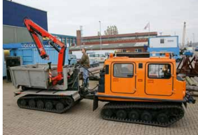
So wird der Lkw-Ladekran zum „Raupe“-Kran. Der Fassi-Kran F 38A 22 im Spezialeinsatz.
