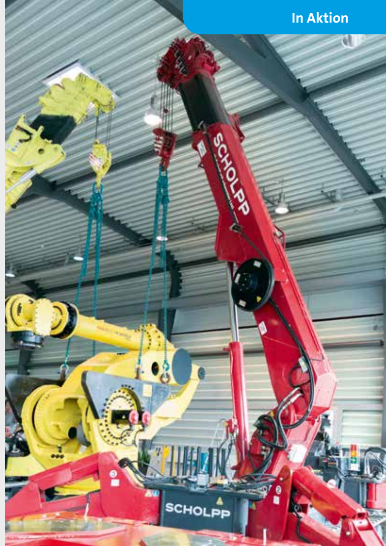
Im Tandem setzen die beiden Minikrane den 11 t schweren Roboter auf eine Platte für den weiteren Transport.
