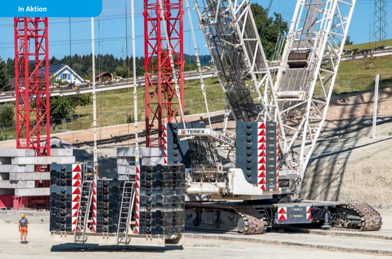
Der Superliftballast beträgt 305 t für die letzten Bögen, da diese am schwersten sind.
