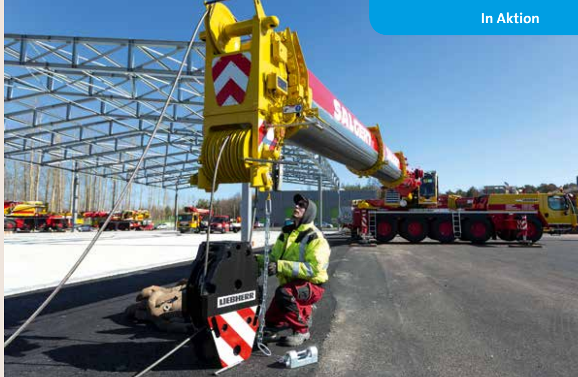
Fabrikneu: Felix Volk schert die Hakenflasche seines Krans ein. Der LTM 1095-5.1 ist der jüngste Neuzugang der Salgert-Kranflotte.
