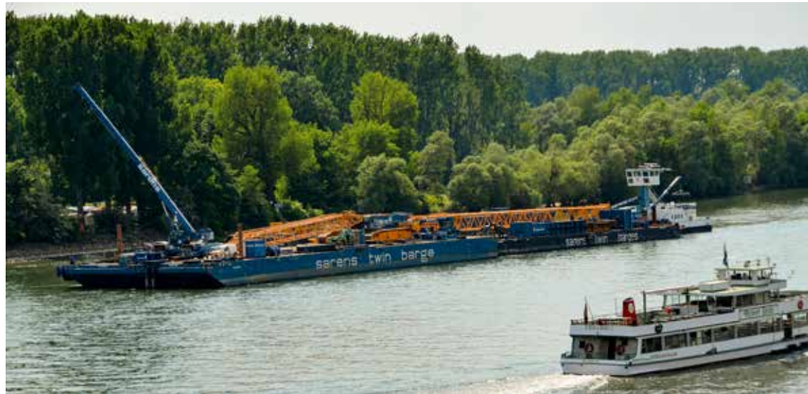
Reisefertig: Das Ponton mit dem CC 2500-1 kann zum Einsatzort geschwommen werden.
