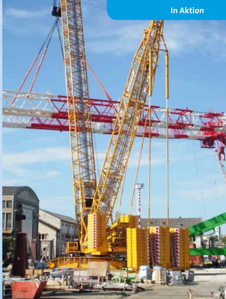
Für den Hub kam der CC 3800-1 mit 225 t Gegengewicht plus zusätzlich 325 t Superlift-Gegengewicht und 50 t Zentralballast zum Einsatz.
