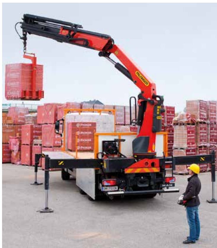
HPSC-Plus LOAD ist nur das erste Modul eines Baukastens, mit dem das bestehende Palfinger-Standsicherheitsüberwachungssystem auf individuelle Einsatzsituationen zugeschnitten wird. In Kürze folgen zwei weitere Module: HPSC-Plus FSTAB, das seine Stärken bei sehr geringen Stützbreiten und bei sehr hoher Beladung am Fahrzeug ausspielt, sowie HPSC-Plus GEOM für die TEC7 Modelle, bei dem auch die Längenmessung am Schubsystem zur Berechnung der Standsicherheit herangezogen wird.
