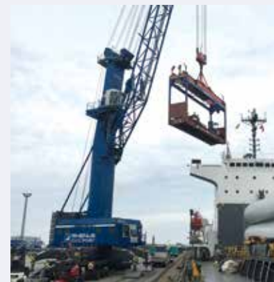
Neben den Liebherr-Kranteilen ließ die japanische Reederei weitere Projektladungen durch Cuxport mittels des eigenen 100 t-Hafenmobilkrans verladen.
