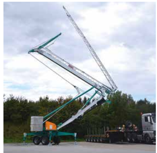
Der CM 271 erhielt ein Upgrade und bietet als CM 271S1 jetzt 2,5 t Tragkraft. BKL zeigt den Kran auf der Nordbau.
