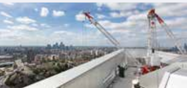
Wurde 2016 vorgestellt: Der Service-Kran von ALE in Leichtbauweise – hier im Einsatz in London.
