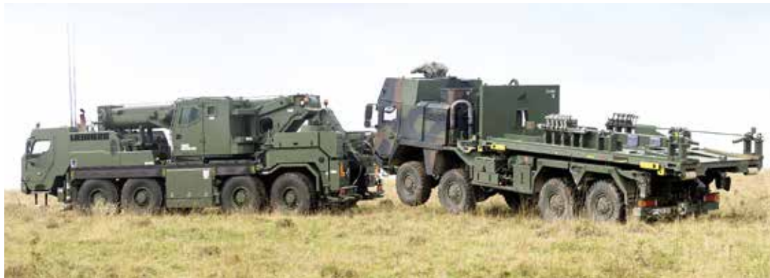
Das Liebherr-Bergekranfahrzeug G-BKF eignet sich zum Bergen und Abschleppen einer Vielzahl von unterschiedlichen Fahrzeugen.
