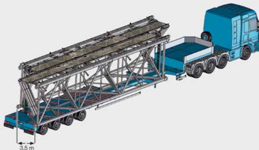
Zum Transport werden die zwei Hälften des SX-Auslegers zu einer Transportbreite von 3,5 m zusammengeführt.
