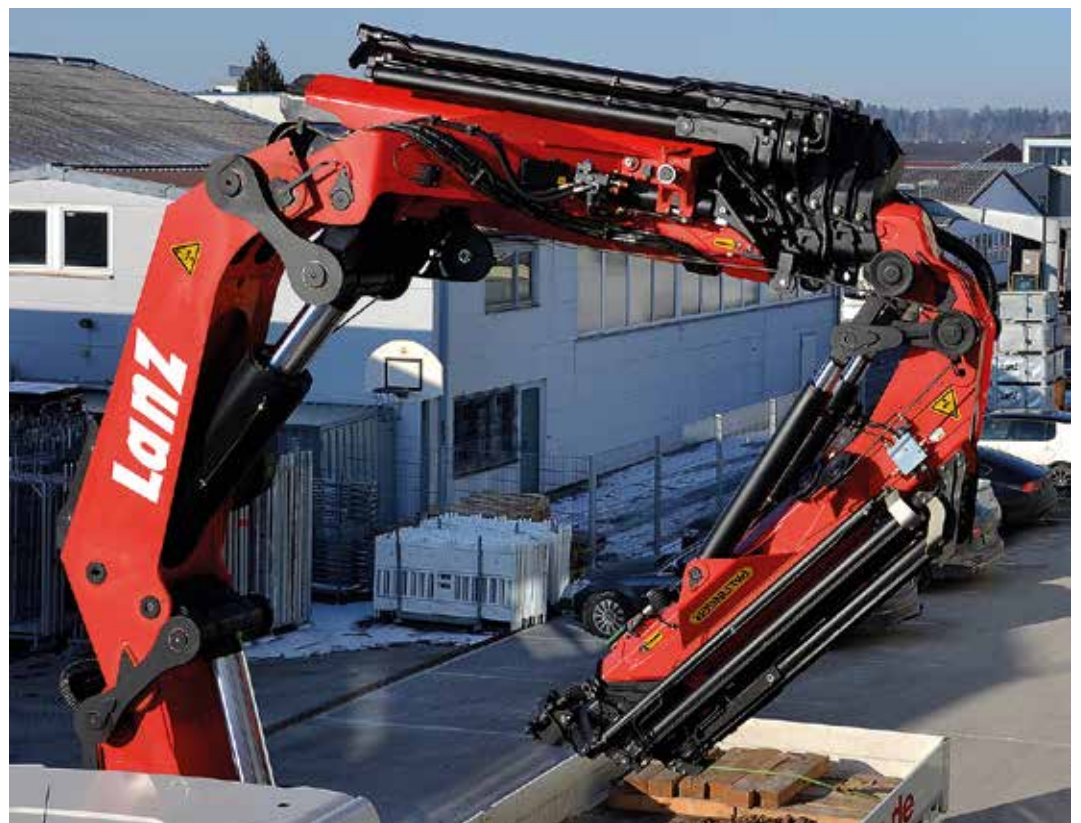
Der PK 92002-SH von Palfinger bietet ein Lastmoment 85,5 mt.
