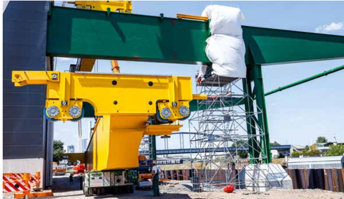
Insgesamt 500 t Tragkraft bietet dieser Zweiträgerbrückenkrane von Brunnhuber.
