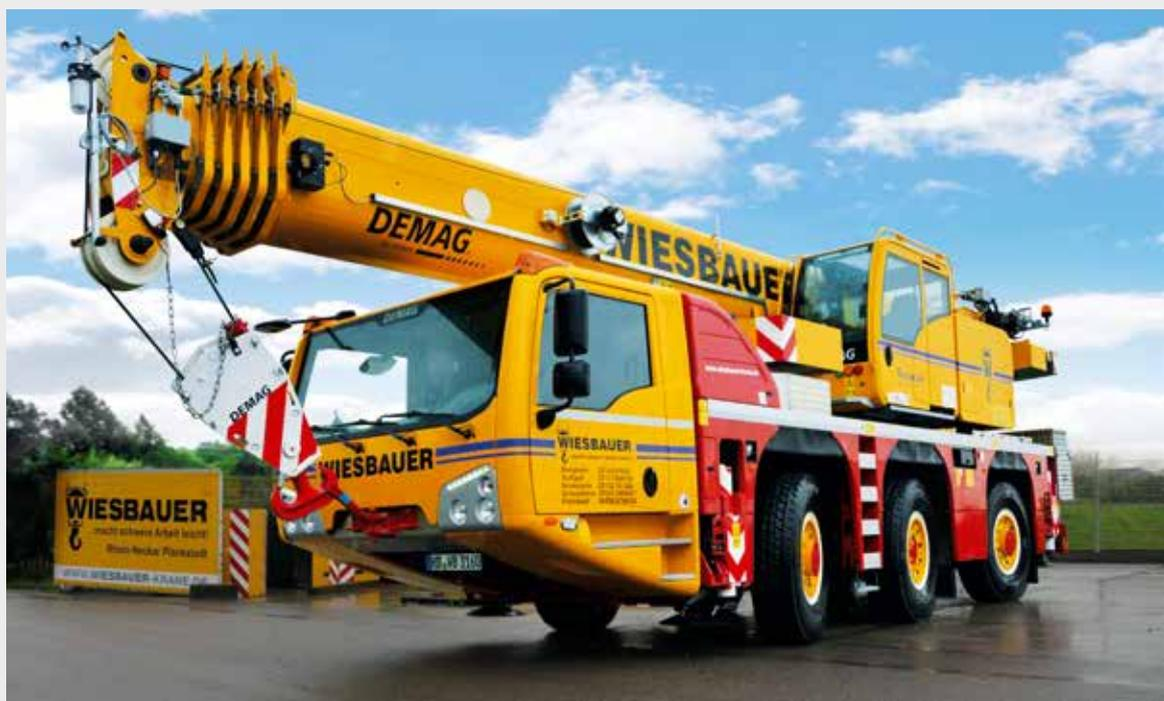
Ein Kran, zwei Konzepte: Innerhalb der 12 t-Achslastbegrenzung kann der Demag AC 55-3 seinen kompletten Ballast mitführen. Der 55-Tonner hat dann alles dabei, denn eine Hauptauslegerverlängerung für den üppigen 50 m langen Teleskopausleger wird für diesen Kran nicht angeboten ...
