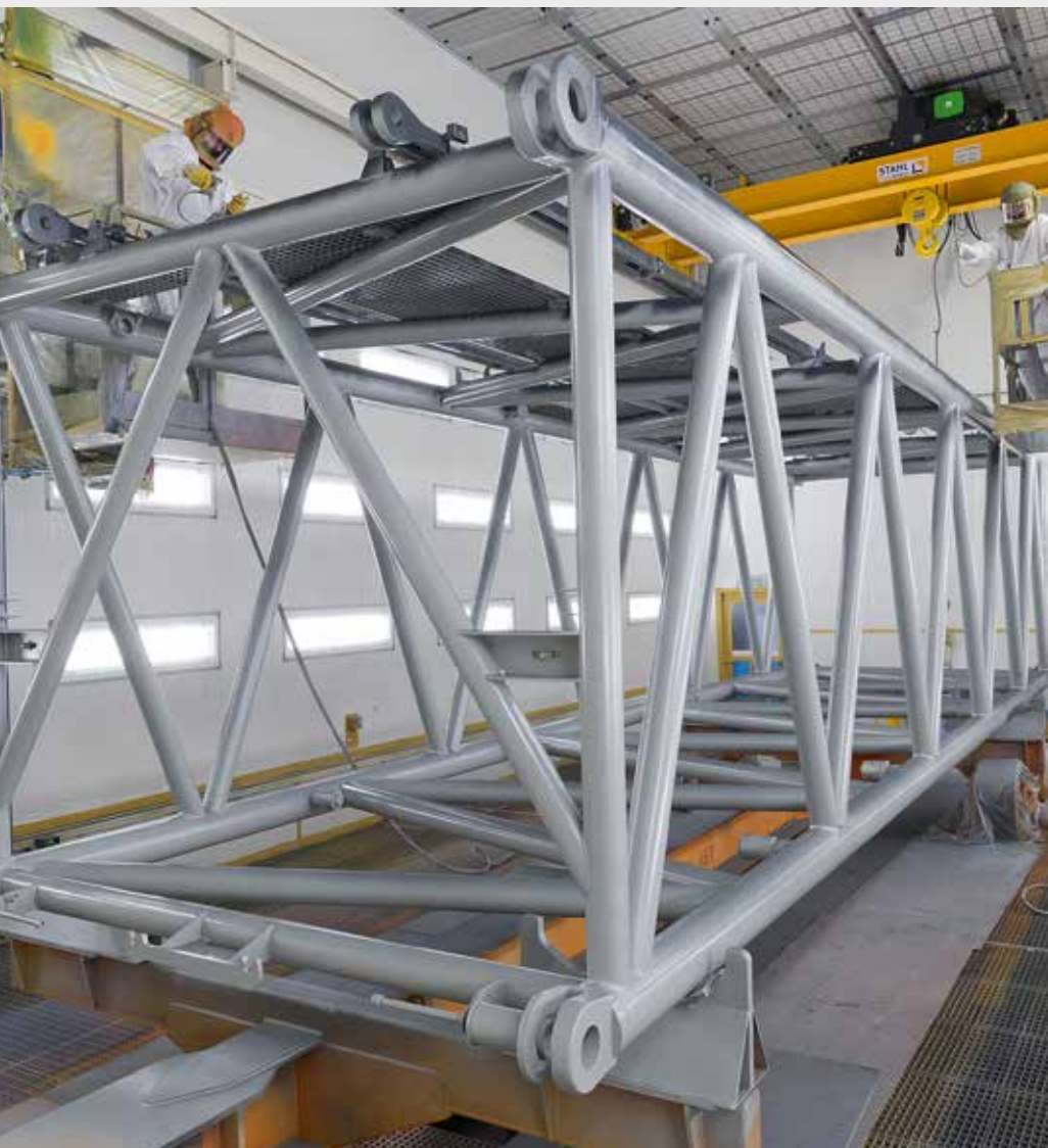
Große Gitterteile von Raupenkränen werden in Lackierboxen, die in die neue Lackierhalle integriert sind, endlackiert.
