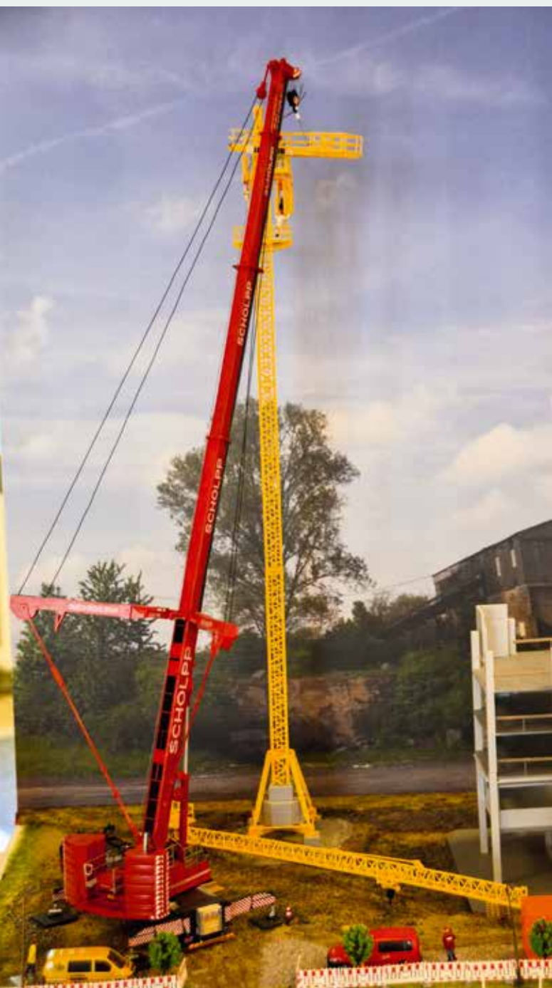
Einsatzfelder für Mobilkrane, maßstabgerecht: Montage eines Turmdrehkrans und Montage einer Windenergieanlage.
