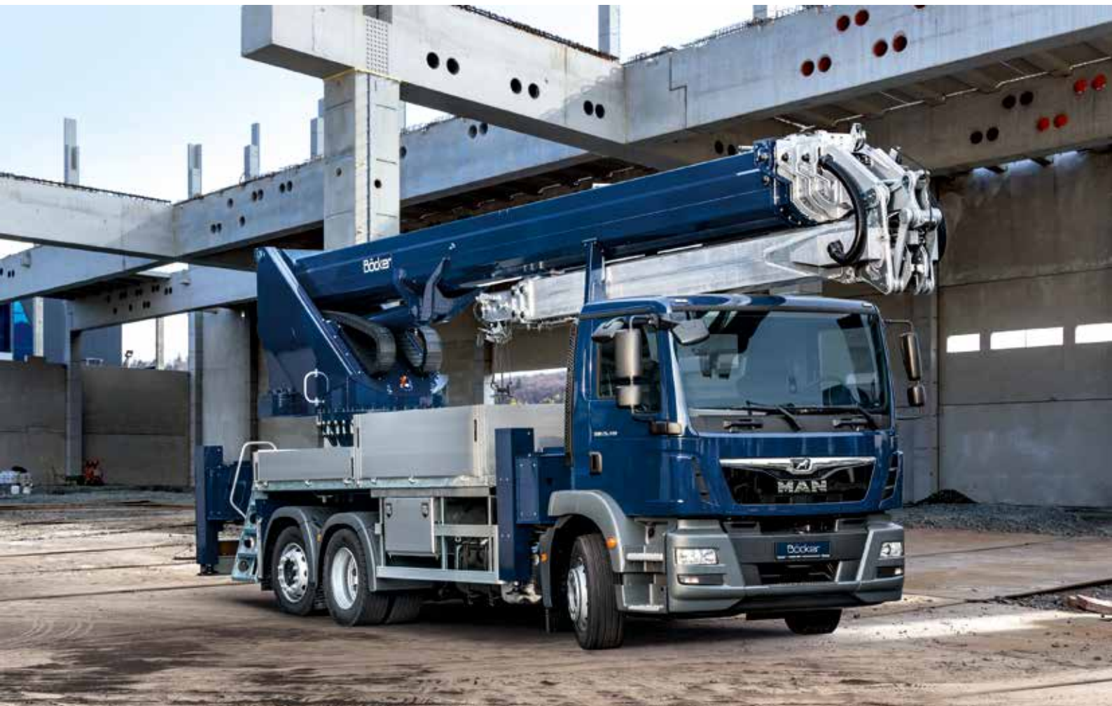
Der AK 52 bietet eine maximale Nutzlast von 12 t und eine Ausfahrlänge von 52 m (optional 55 m).
