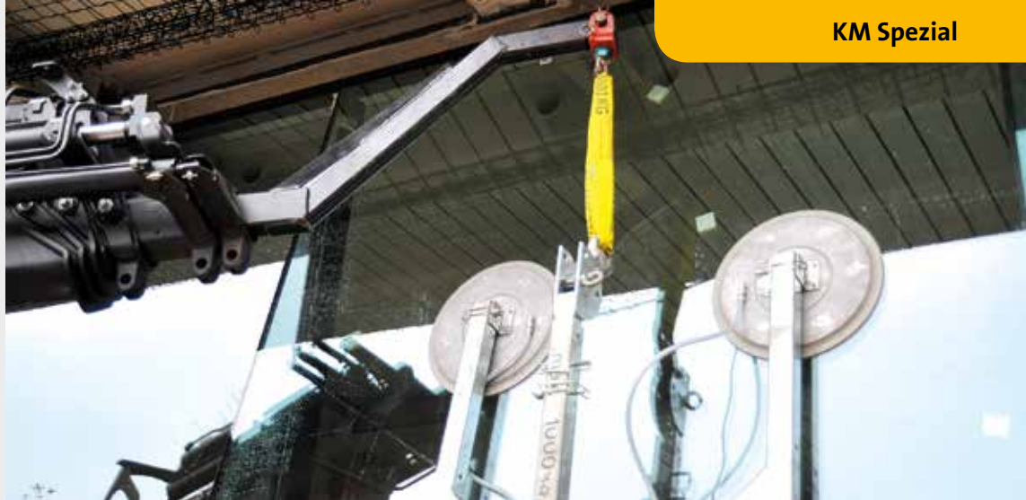
Die Vakuumsaugbatterie hängt am Schwanenhals mit Verkürzer. Sie kann bis zu .1000 kg mittels 8 Saugtellern halten.
