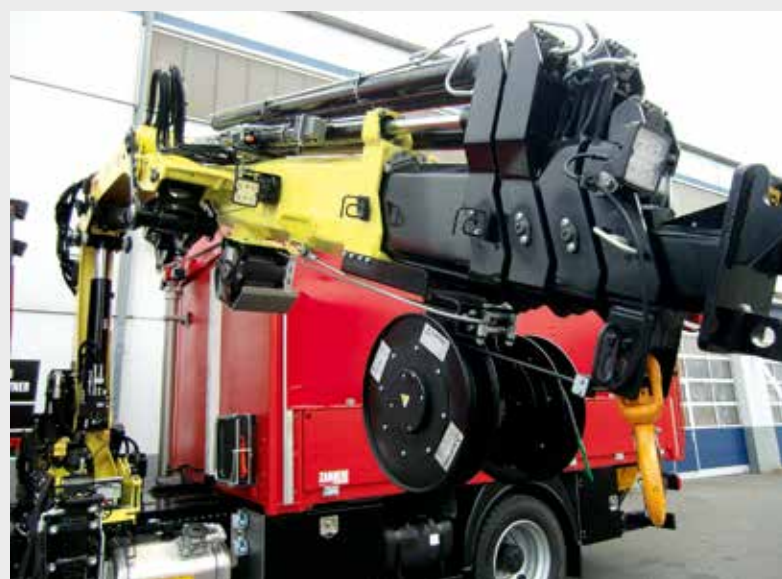
Zu den zahlreichen Ausstattungsdetails des Hiab XS 099 ES4-HiPro für die beiden Freiwilligen Feuerwehren zählen unter anderem eine Seilwinde, ein Beleuchtungsmast sowie ein Starkstromanschluss an der Kranspitze.
