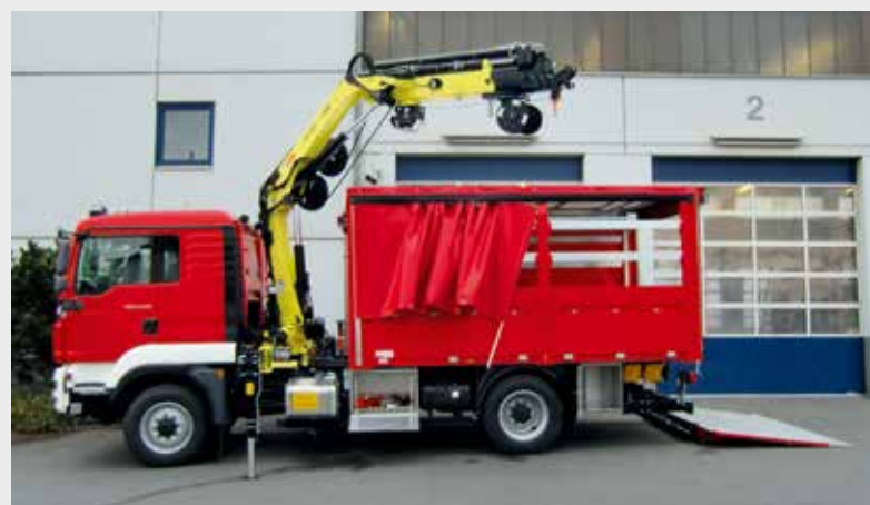
Dank des extrem niedrigen Kranhilfsrahmens schließt der zusammengefaltete Kran bündig mit der Höhe des Versorgungsaufbaus ab.
