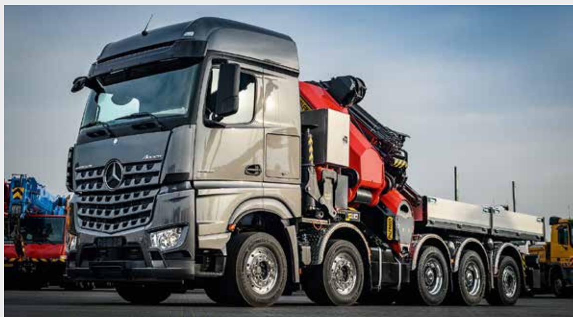
... wurde mit diesem 165 mt-Palfinger-Ladekran auf einem 5-achsigen Arocs realisiert.
