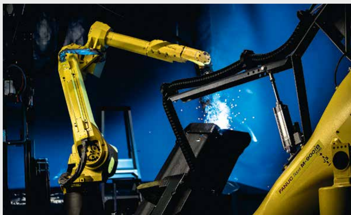
HMF hat nochmals in Schweißroboter investiert. Unter anderem in einen neuartigen Schweißroboter, der adaptives Schweißen mit vollautomatischer Förder-technik verbindet.
