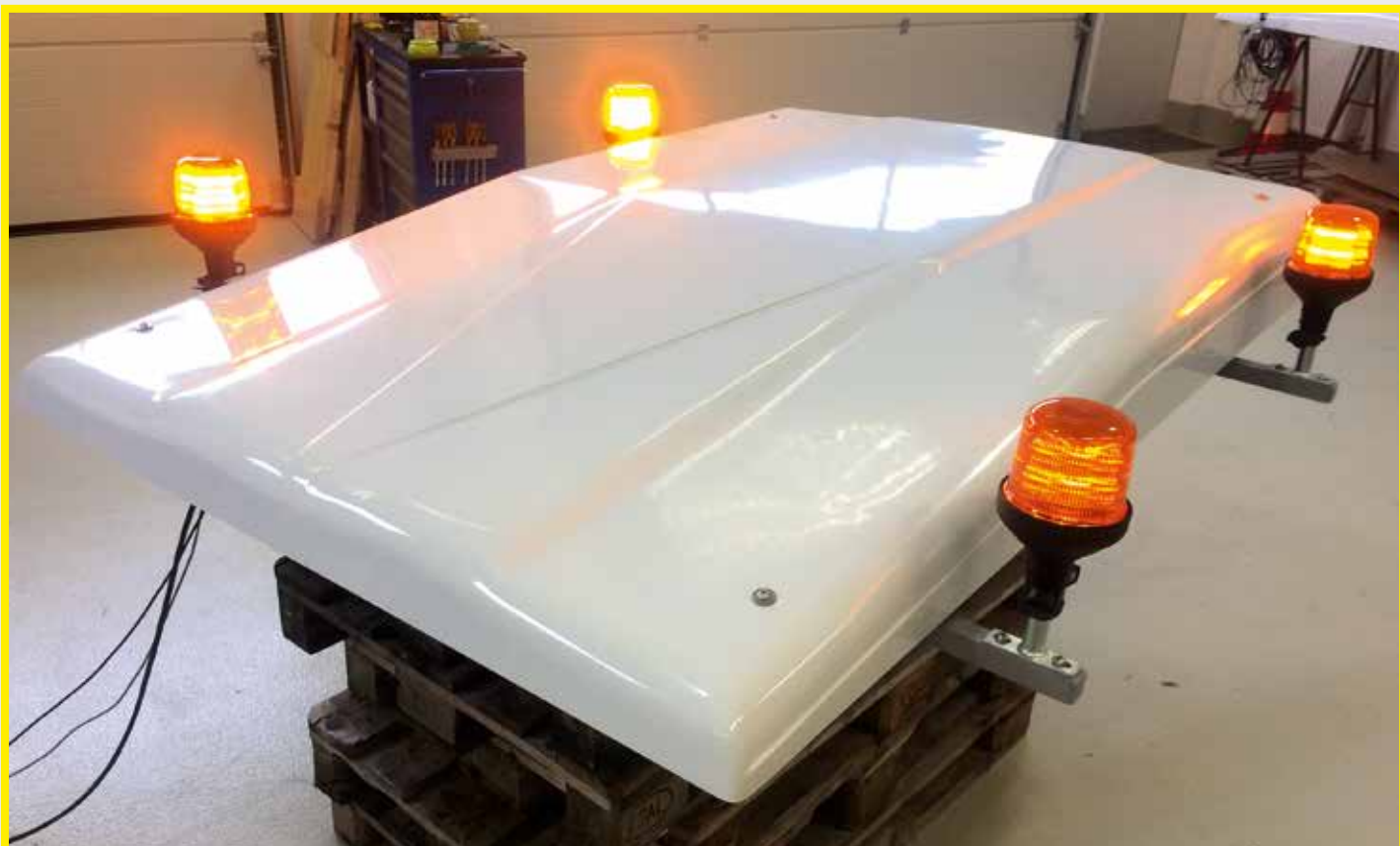
Die Wechselverkehrszeichenanlage BF3 neo-WVZ-Anlage von Kustech bestehend aus: Grundrahmen für Dachmontage mit elektromotorischem Antrieb zum Aufrichten des Wechselverkehrszeichens mit Spoiler. Der Grundrahmen besteht aus pulverbeschichtetem Aluminium, der WVZ-Rahmen und der Schlitten sowie der Spoilerrahmen sind aus feuerverzinktem Stahl in korrosionsbeständiger leichter Bauweise. Der Spoiler ist aus GFK in Sandwich-Bauweise gefertigt. Er ist dadurch sehr formstabil, schwingungsfrei, leicht und die maximale Bauhöhe von 200 mm ermöglicht einen geringen CW-Wert.
