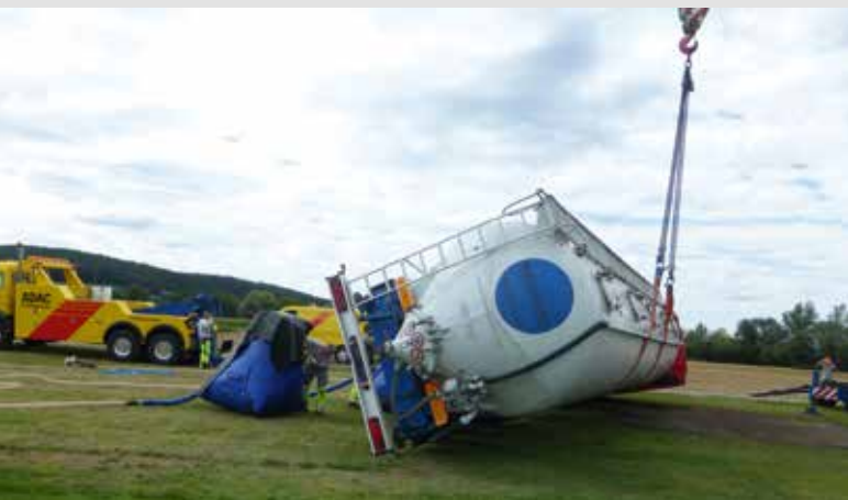
Am Nachmittag des zweiten Seminartages ging es darum, einen auf der Seite liegenden Sattelzug wieder aufzustellen, wobei auch ein Mobilkran eingesetzt wurde. Zum sanften Ablassen waren Catchbags positioniert.
