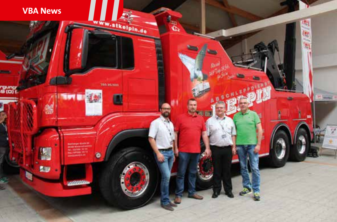
Der EH/W 200 BISON wurde von EMPL während der IFBA an das in Sachsen ansässige Unternehmen „Abschleppdienst Kelpin“ übergeben. Die Basis des Fahrzeugs bildet ein MAN TGS 35.500 8x6 H-Fahrgestell. Das Fahrzeug ist mit einer 30 t-Hauptwinde sowie einer 15 t-Winde am Hauptarm ausgestattet. Hinter und unter dem Fahrerhaus montierte Ballastgewichte mit insgesamt rund 3,2 t sorgen für ausreichend Sicherheit beim Abschleppvorgang. Das Abschleppzubehör ist KTL beschichtet.
