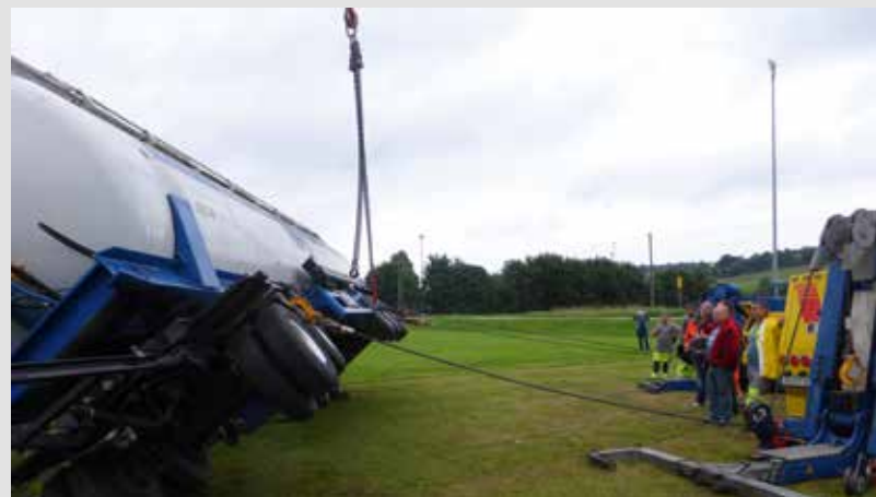
Am letzten Seminartag startete der Praxisteil mit einer weiteren Bergungsvariante. Dabei lag der Sattelzug wieder auf der Seite. In diesem Durchgang wurde vor der eigentlichen Bergung der Sattelzug getrennt.
