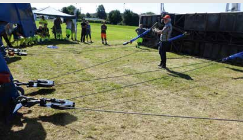
Wieder ein Bus, wieder in Seitenlage. Bei der Bergung mit Seilwinde wurden insgesamt sechs Umlenkrollen eingesetzt. Ein Zugkraftmessgerät verdeutlichte, inwieweit die benötigten Zugkräfte durch den Einsatz der Umlenkrollen reduziert werden.
