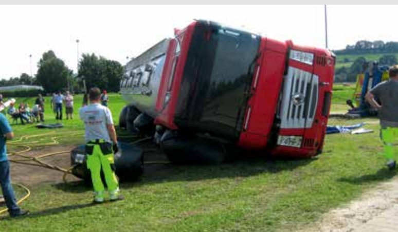
Letzte Berge-Aufgabe am ersten Tag: Bergung eines auf der Seite liegenden Sattelzuges mit Hilfe von Luftkissen.
