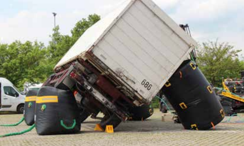
ProLux und Savatech zeigten während der IFBA in einer spektakulären Vorführung, wie ohne Zuhilfenahme eines Telekrans, ein umgestürzter Lkw-Kofferranhänger sicher und beschädigungsfrei – durch Zuhilfenahme zweier Hebekissen - zurück auf die Räder gestellt werden kann.
