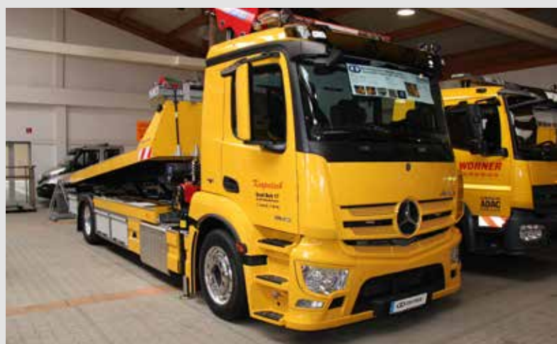
Der LFB(K) stellt das Basisfahrzeug im Abschleppbetrieb dar – hier ein Produkt des Aufbauherstellers Tischer: MB Antos 1843 mit einem Edelstahlplateau Bavaria 4000, einer 5 Hubbrille und einem Ladekran von HMF Typ 2130/T5.
