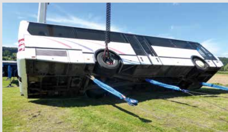
Wieder ein Bus, wieder in Seitenlage. Bei der Bergung mit Seilwinde wurden insgesamt sechs Umlenkrollen eingesetzt. Ein Zugkraftmessgerät verdeutlichte, inwieweit die benötigten Zugkräfte durch den Einsatz der Umlenkrollen reduziert werden.
