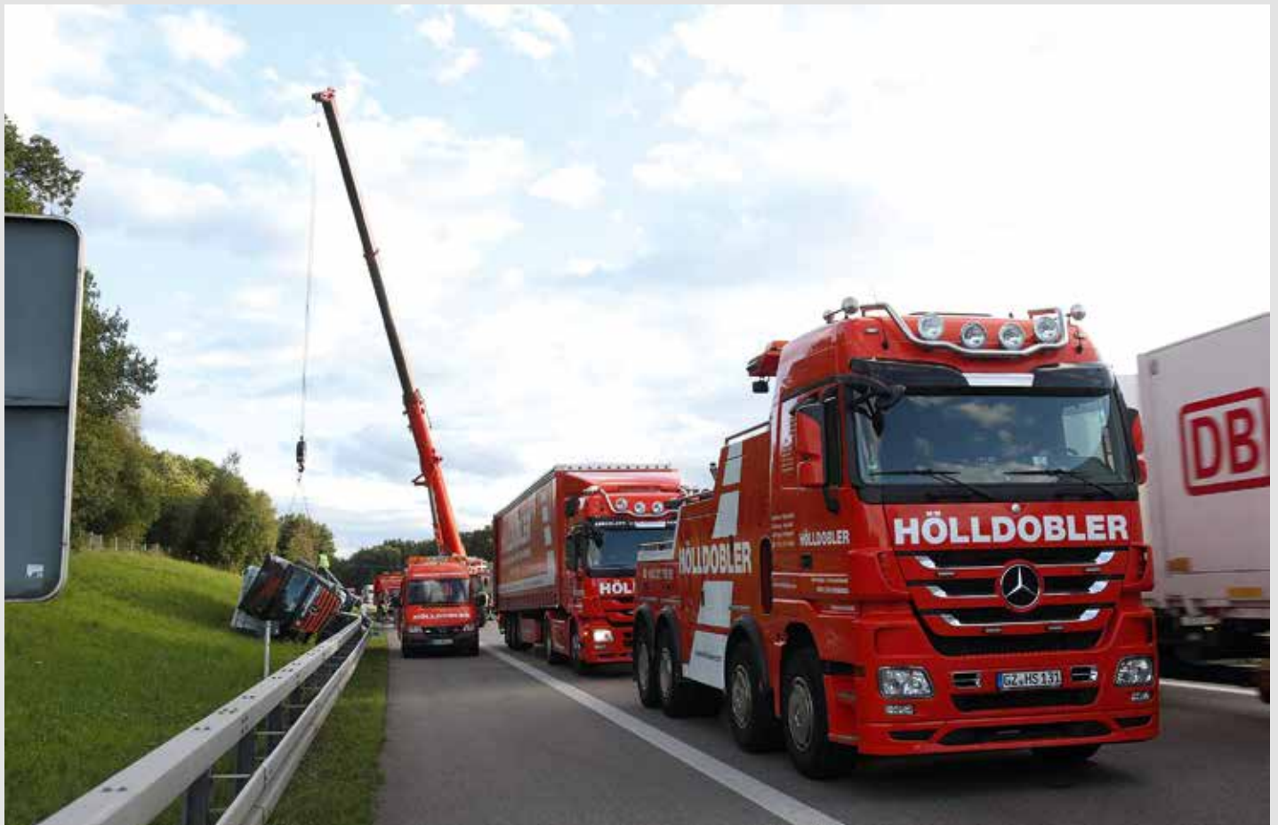
Die Hölldobler GmbH setzte für die Bergung zwei Mobilkrane ein. Zunächst hob ein Mobilkran die gesicherten Gitterboxen aus dem Auflieger.
