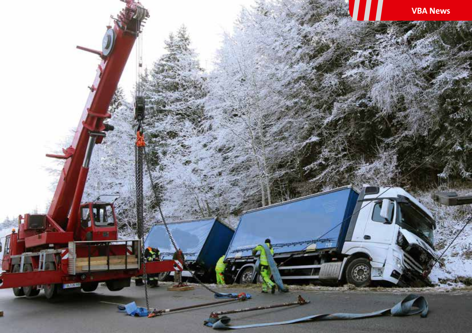
Der Motorwagen des Gliederzugs wird für die Bergung vorbereitet.
