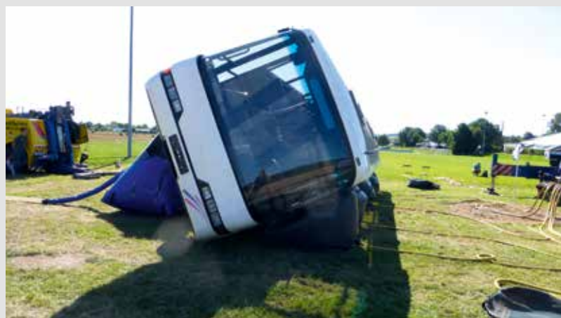
Am zweiten Tag stand wieder eine Bergung mit Luftkissen an. Dieses Mal lag ein Bus auf der Seite und sollte aufgerichtet werden.
