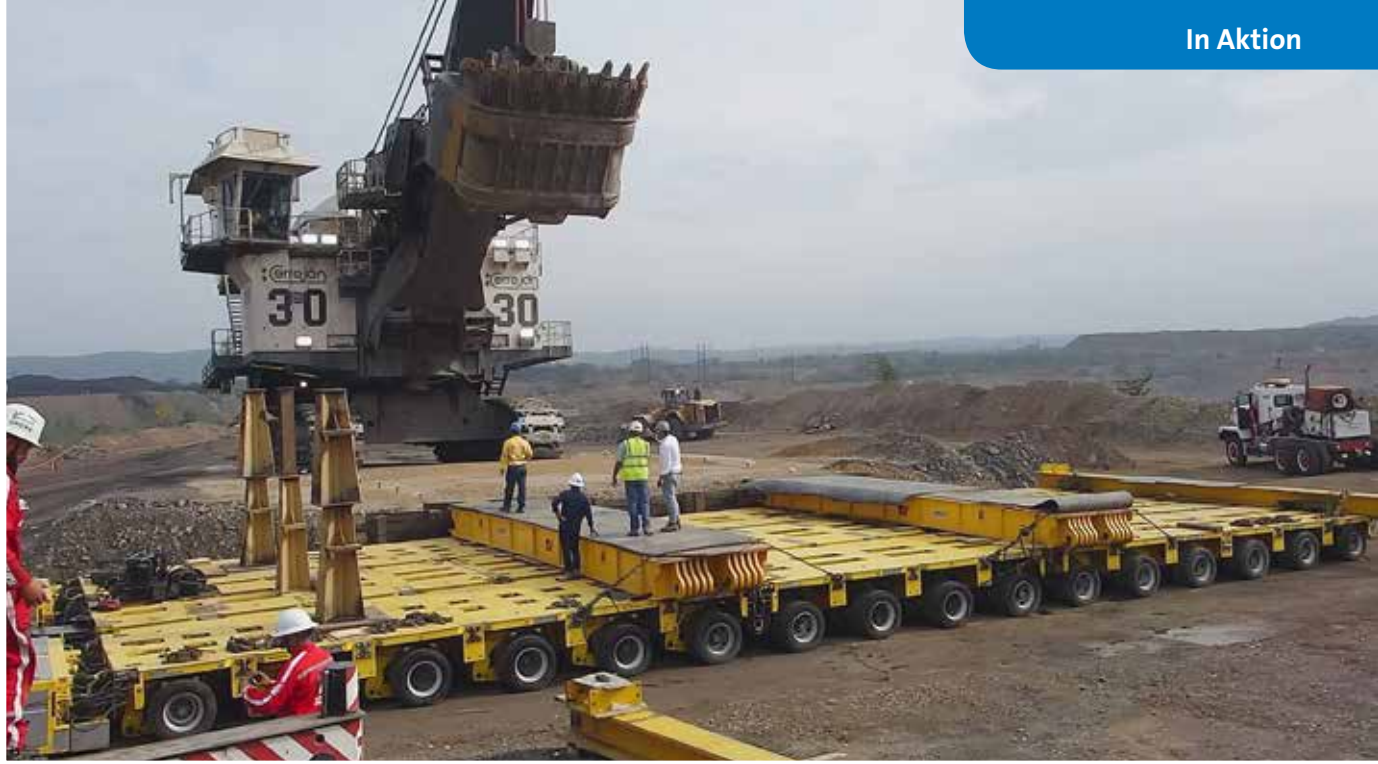
Über eine stabile Auffahrtrampe wurde die 3-fach-Kombination mit dem 1.200 t schweren Minenbagger befahren.
