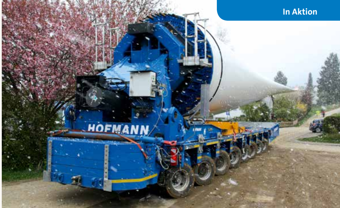
Die 65 m langen Rotorblätter wurden auf einer Fahrzeugkombination aus PST und FTV 300 befördert.
