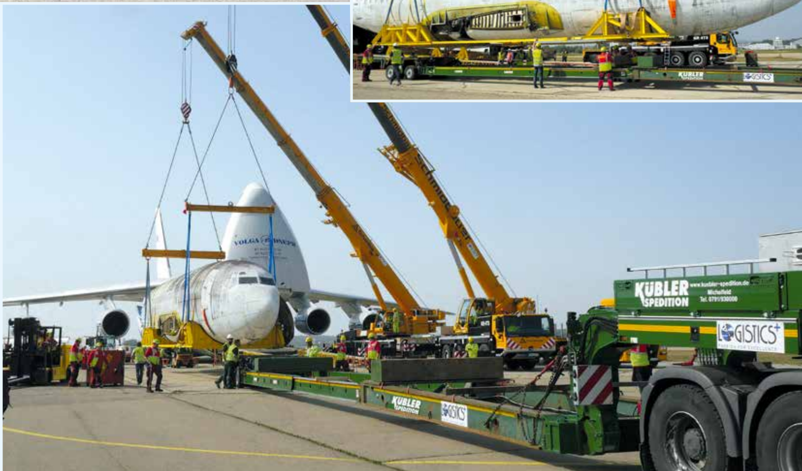
Kostbare Fracht: Behutsam wird der geschichtsträchtige Rumpf auf dem Scheuerle UltralightCombi abgesetzt. Praktisch: Die Scheuerle Kesselbrücke wurde genehmigungsfrei nach Friedrichshafen gefahren und vor Ort verlängert. So war ein schneller und unkomplizierter Einsatz möglich.
