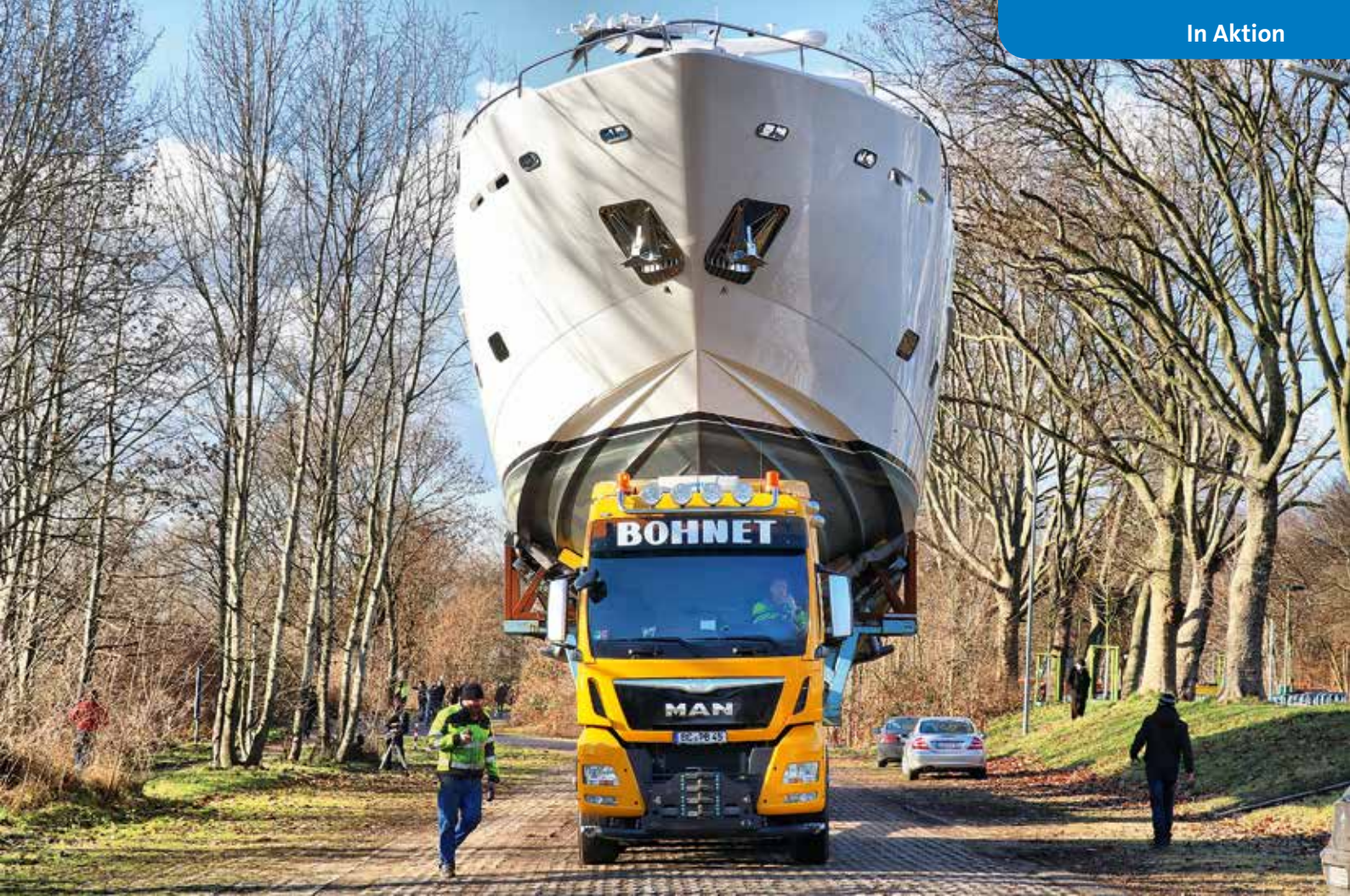
10 Meter über dem Boden: Der hohe Schwerpunkt erfordert absolutes Fingerspitzengefühl.
