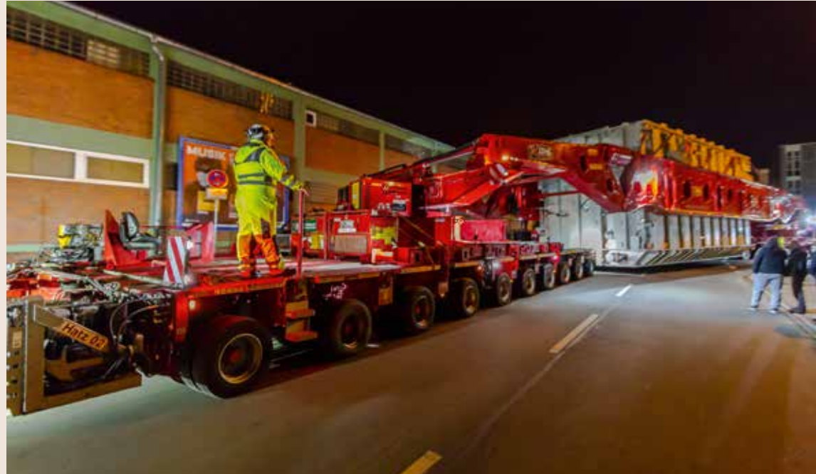
Bei dieser Ladung handelte es sich um ein echtes Schwergewicht: den derzeit leistungsstärksten Transformator der Welt, 1100 KV UHVDC von Siemens, mit einem Eigengewicht von insgesamt 535 t.
