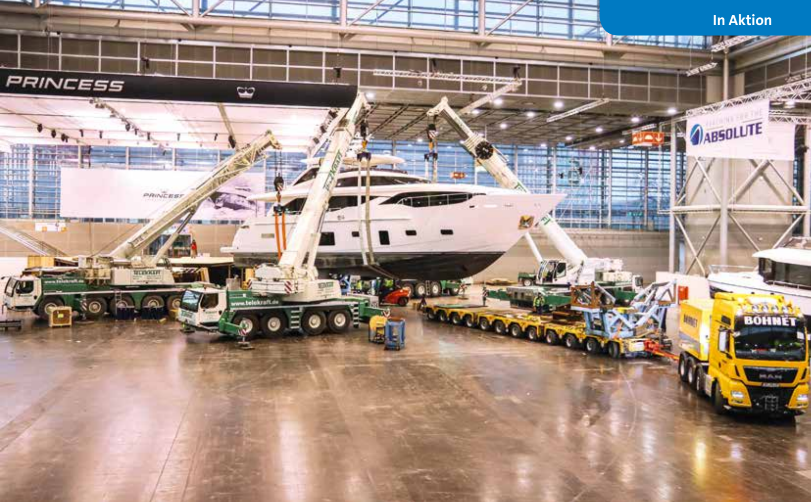
Die Luxus-Yacht hängt am Haken, die Schwertransporteinheit wird unter ihr weggefahren.
