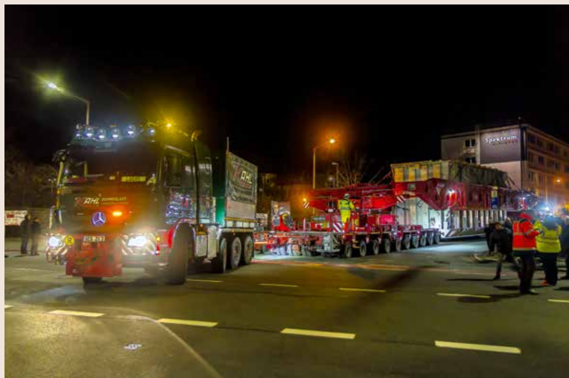
Für den Straßentransport weltrekordverdächtige 875 t Gesamtzuggewicht brachte dieser Transport auf die Waage.
