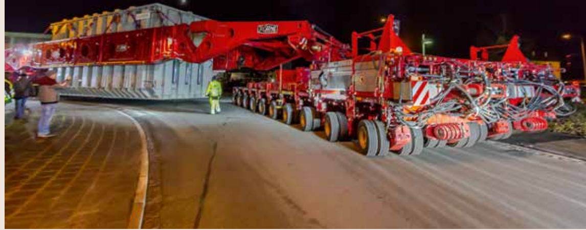
Bei dieser Ladung handelte es sich um ein echtes Schwergewicht: den derzeit leistungsstärksten Transformator der Welt, 1100 KV UHVDC von Siemens, mit einem Eigengewicht von insgesamt 535 t.
