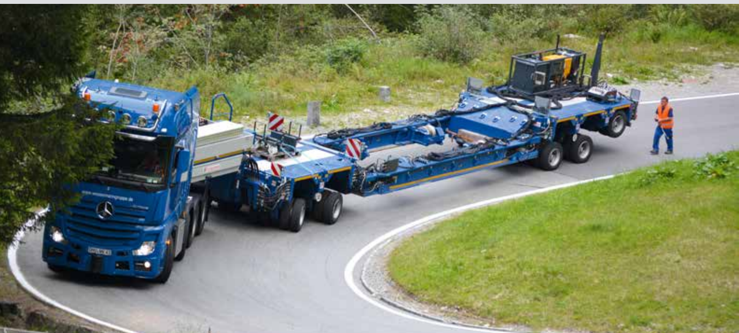
Serpentinen-Fahrt in den österreichischen Alpen. Gut zu sehen ist die Rahmenbrücke, welche die Kabeltrommeln für den Transport aufnimmt.
