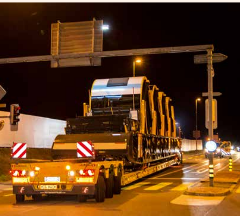
Mithilfe einer Seitenstraße wird gewendet, der Bahnwagen passt grad unter der Schilderbrücke durch.
