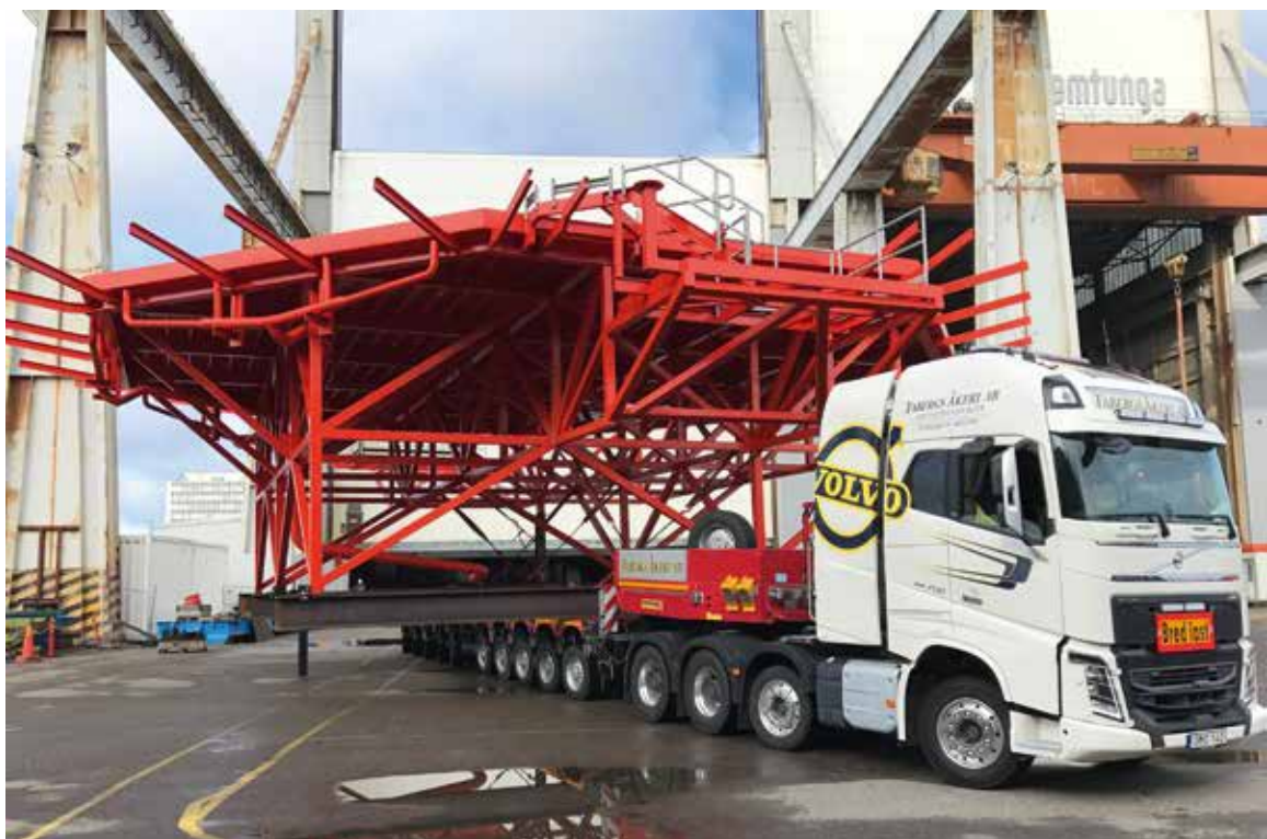
Gewaltige Abmessungen: Ein 24 m langes und 34 m breites Stahlgerüst ...
