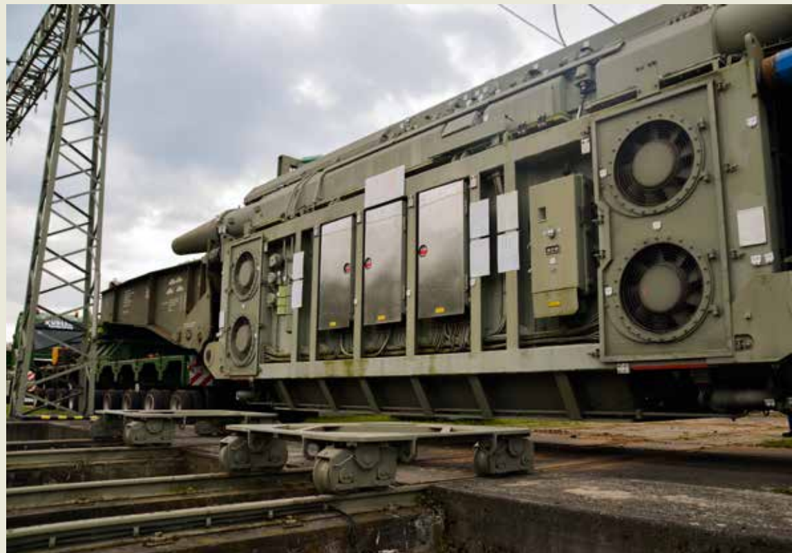
Mittels einer Umsetzbahn erfolgt die Verladung auf die Achslinien.
