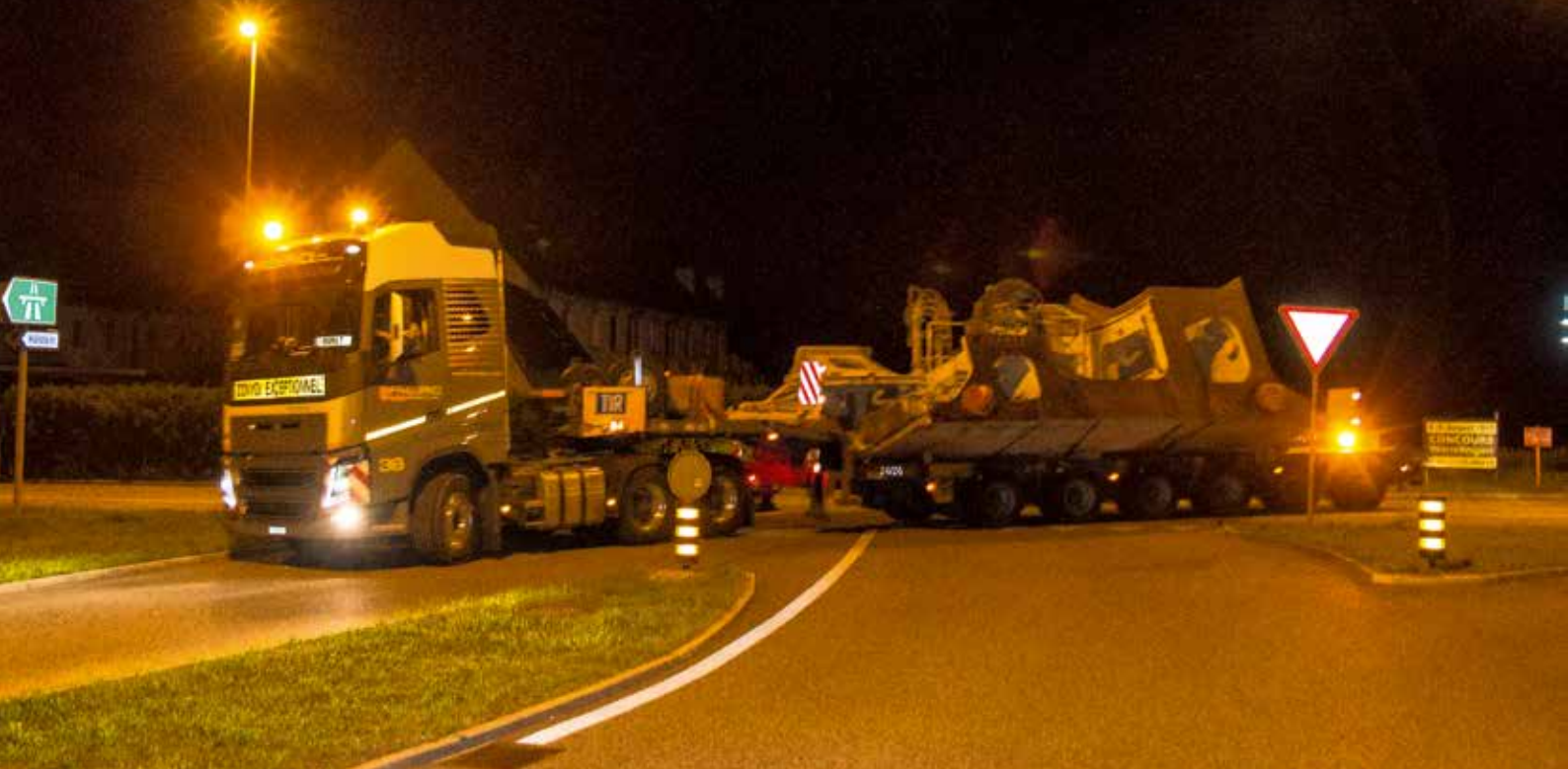
Das 5,9 m breite Schildsegment auf dem Weg nach Balsthal. Der Transport brachte es auf ein Gesamtzuggewicht von 84 t.
