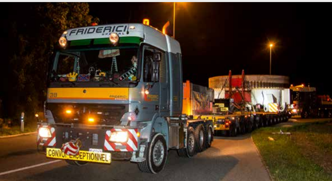
In der Nacht wurde der 155 t schwere Antrieb der Tunnelbohrmaschine transportiert.
