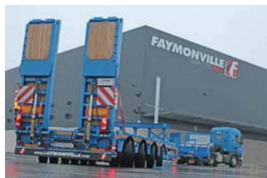
Der neue Faymonville Semi für Kurz lässt sich auf 21.700 mm verlängern.
