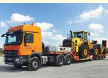
Die Radmulden des STZ-L 4 verringern die Gesamtladehöhe.
