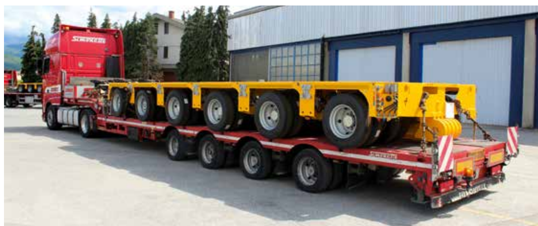
Die MGSL-Module von Cometto bieten eine technische Achslast je Achslinie von 45 t. Die Serie ist verfügbar mit einer Breite von 3.000 mm und Fahrwerken mit 2 bis 6 Achslinien. Es kann in Kombination mit einem Power Pack (PPU) auch als selbstfahrendes Fahrzeug genutzt werden.
