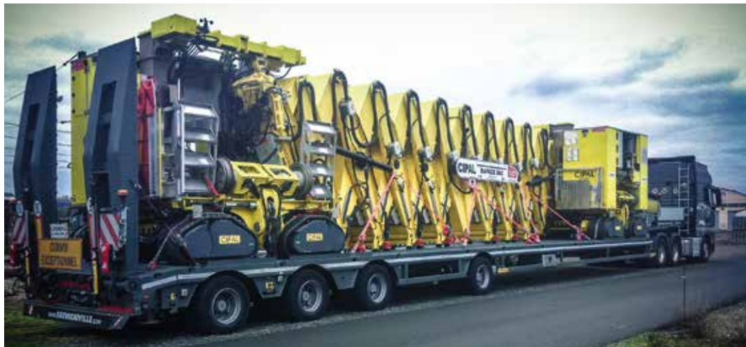
38 t wiegt die Spezialmaschine, die SNCF Réseau aus Frankreich auf ihrem neuen Faymonville MultiMAX 1+3 transportiert.
