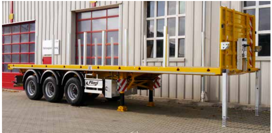
Mit den Plateauaufliegern des Typs SDS 460 von Fliegl transportiert Kran-Maier Kontergewichte. Im Stand unterstützen je zwei ausziehbare Klappstützen die 24 t-Stützwinde.
