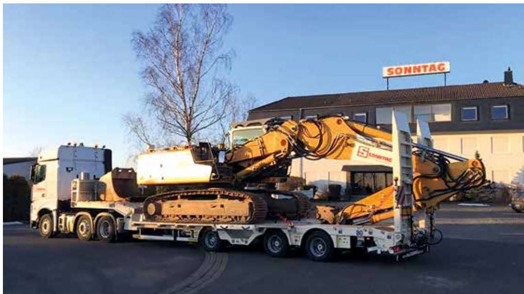
Der neue 1+2 MultiMAX Plus, den Faymonville an die Firma Sonntag geliefert hat, verfügt über eine automatische Liftfunktion der ersten Achse.
