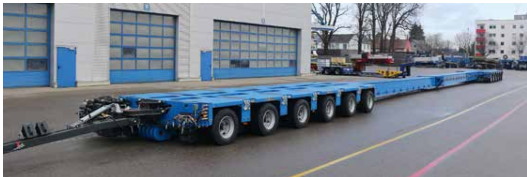
Die Fahrzeugkombination THP/SL mit ihren teleskopierbaren Spacern bietet ideale Voraussetzungen für den Transport der überlangen Betonträger in Kuala Lumpur.
