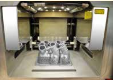
Frisch aus dem 3D-Drucker: Ersatzteile aus Metall.
