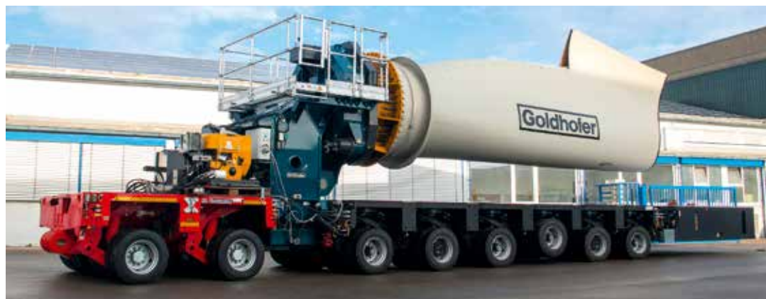
Dank eines Rotorblatt-Dummys können die Transportexperten von Denzai das Handling ihrer neuen FTV 500 auf dem Goldhofer-Werksgelände in Memmingen erkunden. Foto: Goldhofer
