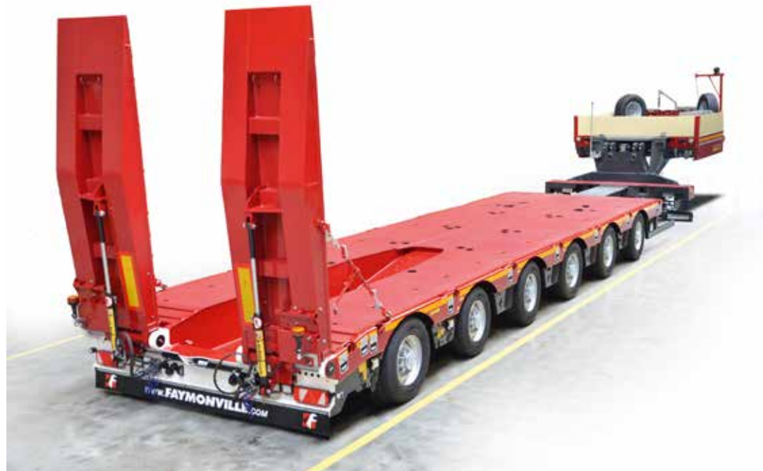
Neu und groß: Löffelstielmulde für Faymonville-Fahrzeuge mit niedriger Pendelachse. Letztere ermöglicht 790 mm Ladehöhe, 60° Lenkeinschlag und 600 m Hub.
