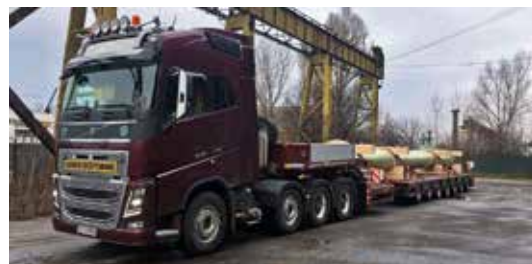
Solch einen 7-achsigen SL2 Semi-Tieflader hat Autoservice S.R.O. für den Transport übergroßer Container angeschafft.
