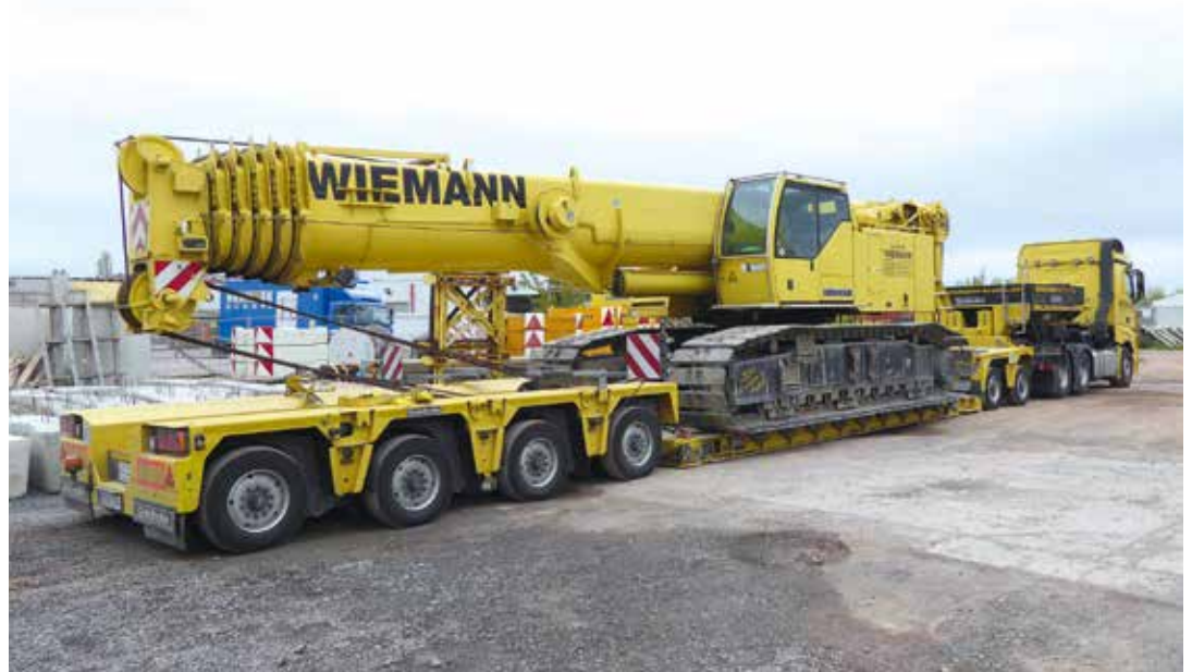
Bereit zur Abfahrt: Der Liebherr LTR 1100 steht sicher auf der Tiefbettbrücke des Goldhofer STZ-VO 6. Das Fahrzeug überzeugte bei Wiemann auch durch seine Pendelachstechnologie den großen Lenkeinschlag und 600 mm Hub.
