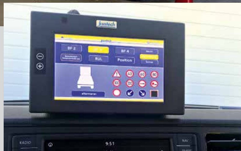
Schön übersichtlich und intuitiv bedienbar – das Bedienelement für die WVZ: 8"-Monitor mit Touchscreen und Industrie-PC.
