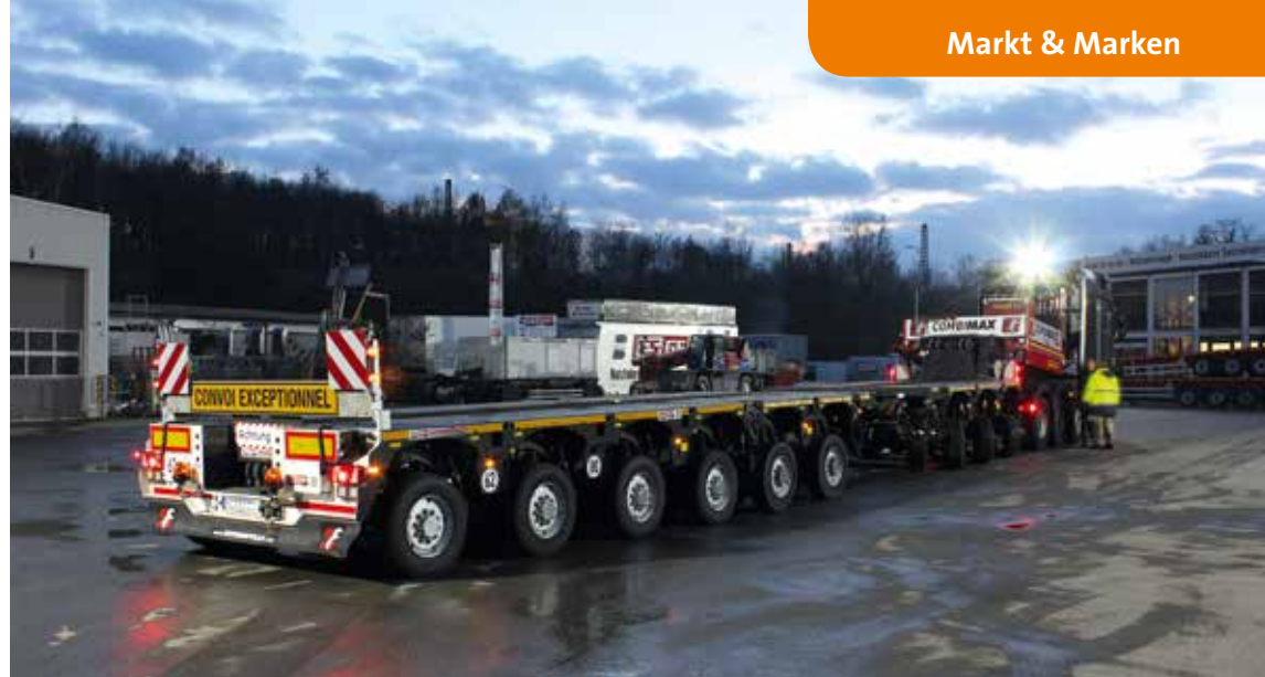
Insgesamt neun Achslinien aus dem modularen Baukastensystem CombiMAX hat die ES-GE vorbereitet und den kompletten Zug inklusive Sattelzugmaschine an Europatrans übergeben.
