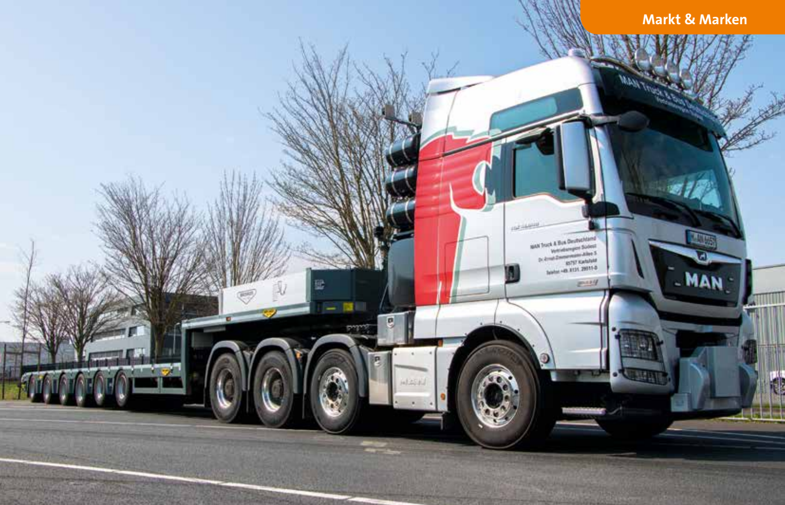
Mit dem leistungsstärksten MAN-Motor, der TC-Tronic HD und in voller Schwerlastausführung ist der TGX 41.640 8x4/4 fit für Gesamtzuggewichte bis 250 t.
