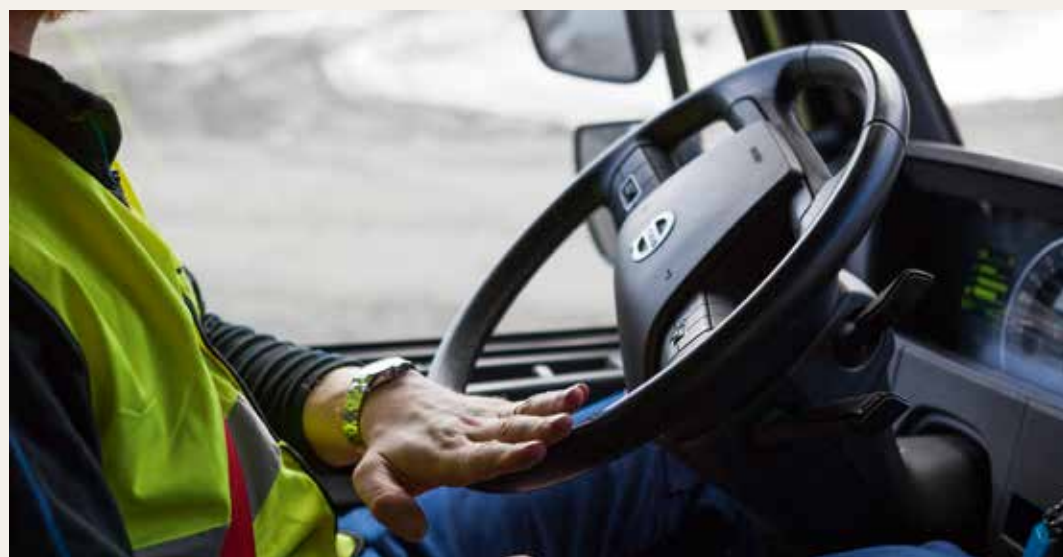
Volvo Dynamic Steering wurde 2013 eingeführt. Durch das Überprüfen der Lenkabsicht des Fahrers (2.000 Mal pro Sekunde) und das Ausgleichen von Fahrbahn- und Windeinflüssen reduziert sich der Lenkkräftaufwand erheblich. Dies wiederum verringert die Belastung der Rücken- und Nackenmuskulatur des Fahrers.
