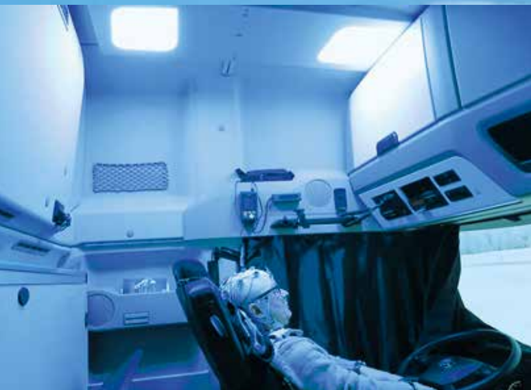
Daylight+: Forscherteam der Daimler AG findet dank Sensoren heraus, dass zusätzliches Licht das mentale Befinden des Truckers positiv beeinflusst.
