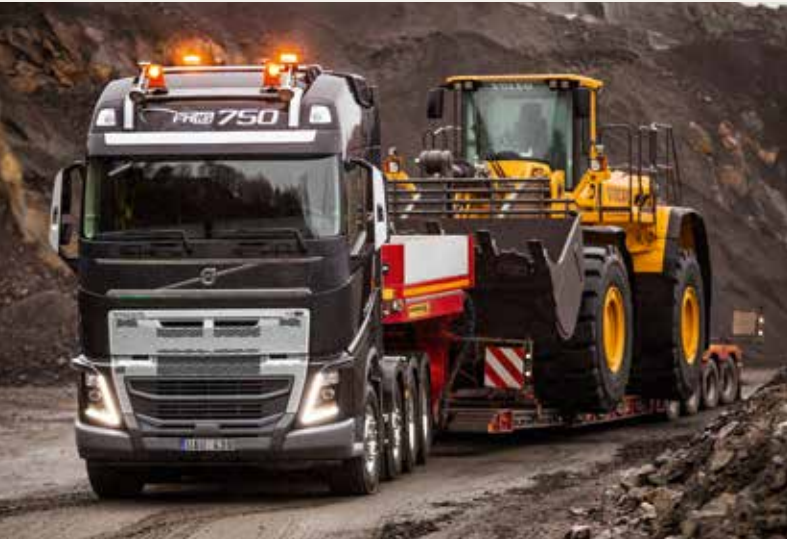
2016 führte Volvo das I-Shift Getriebe mit Kriechgängen ein. Die neuen kurz übersetzten Gänge ermöglichen dem Volvo FH das Anfahren mit noch schwereren Lasten auf schwierigem Terrain.
