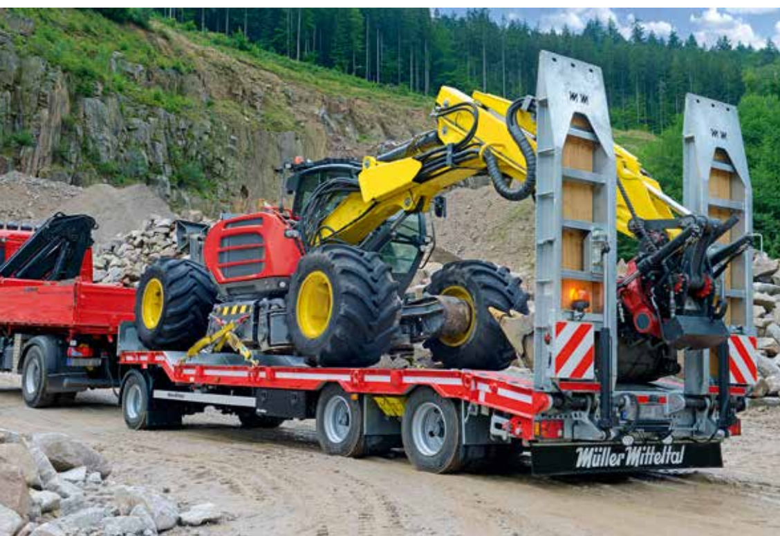
Das wertvolle Arbeitsgerät des Baggerspezialisten ist durch die funktionelle Ladungssicherung auf dem Tieflader professionell gesichert.
