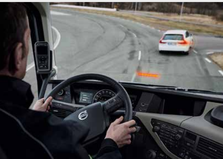
Per Kamera und Radar überwacht das System vorausfahrende Fahrzeuge. Bei drohender Kollisionsgefahr wird der Fahrer mit mehrstufigen Licht- und Tonsignalen gewarnt.
