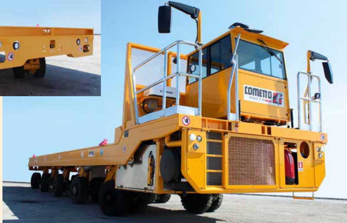
Die ETH-Produktpalette von Cometto bietet Stahlbaufahrzeuge mit Nutzlasten von 20 bis 400 t und flexibel positionierbare Bedienerkabinen.
