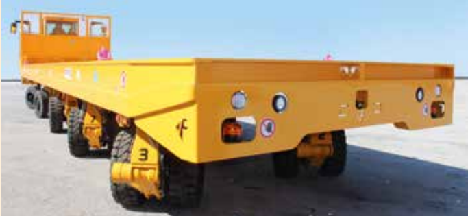
Die ETH-Produktpalette von Cometto bietet Stahlbaufahrzeuge mit Nutzlasten von 20 bis 400 t und flexibel positionierbare Bedienerkabinen.
