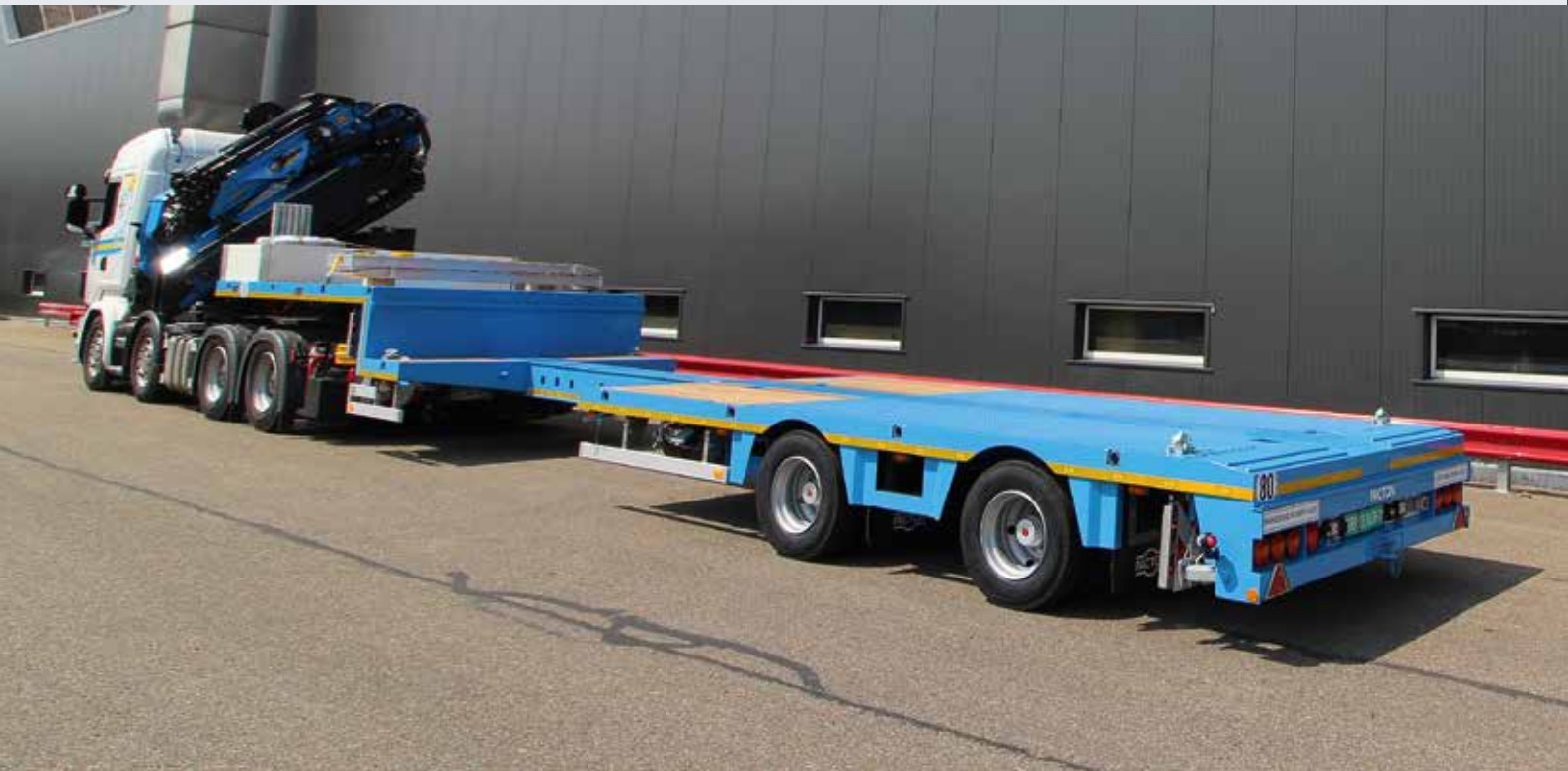
Der Pacton-Semitieflader bietet zwei gelenkte Achsen und ist mit Tridec HF E Lenkung ausgerüstet.
