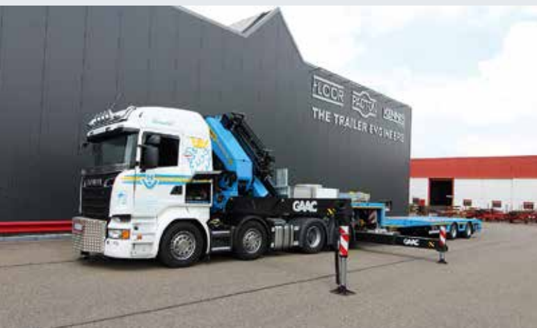
Dank der niedrigen Höhe von 90 cm können auch höhere Containerteile problemlos transportiert werden.
