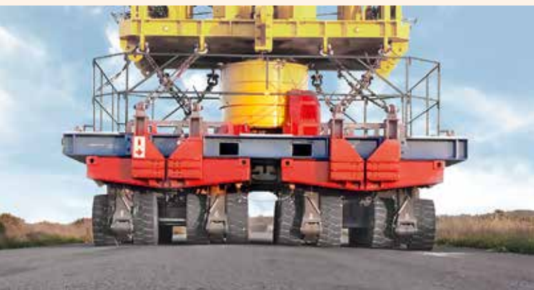
Einsatz eines SPMT Light von Scheuerle.
