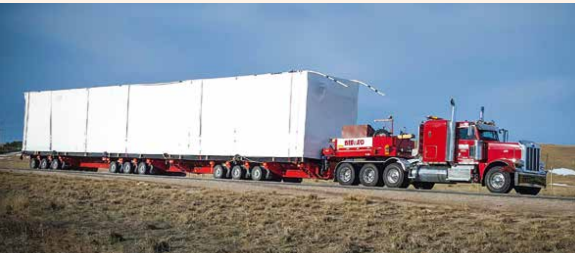
Ein Highway-Trailer von Faymonville in einer für europäische Verhältnisse sehr ungewöhnlichen 3+3+3-Ausführung kombiniert mit einer 4-achsigen Zugmaschine.
