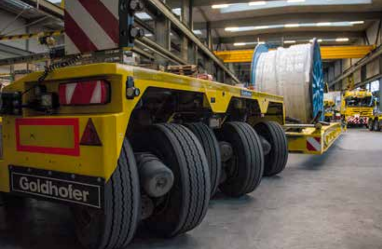
Die mittlere Kesselbrücke, darin die Kabeltrommelträger.
