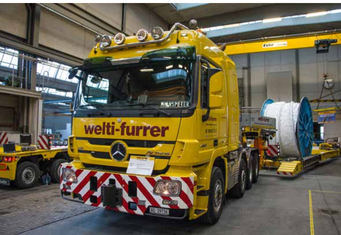
Actros MPlII 4160 mit der mittleren Kesselbrücke, zwischen den Trägern die Kabeltrommelträger zum Kabeltrommeltransport.
